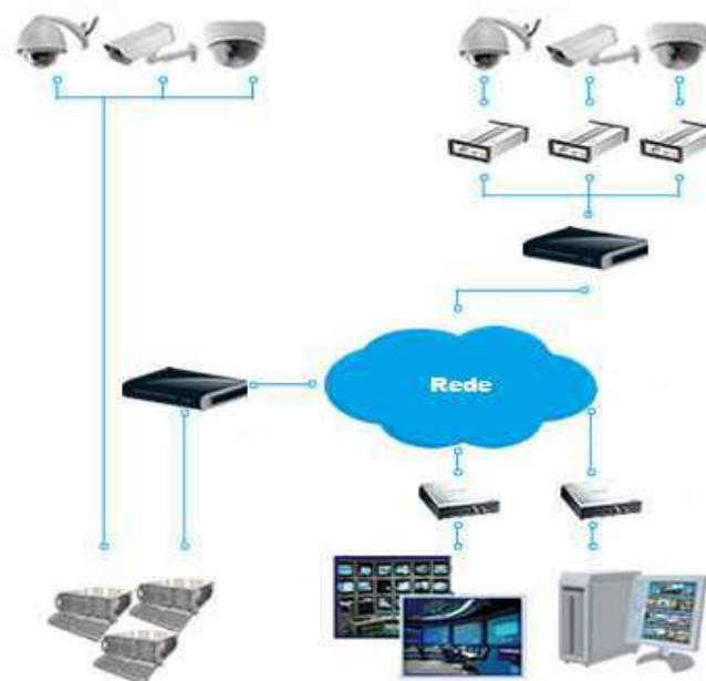
Figura 2: Exemplo de um sistema típico de videovigilância. Adaptado de (TEAM, 2000c).
