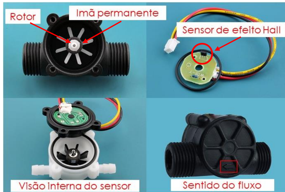
Figura 5 - Visão geral e interna do sensor de fluxo
