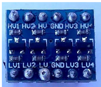
Figura 14 - Conversor de nível de tensão
