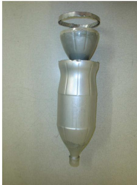
Figura 1 – Vista da montagem do pluviômetro alternativo.
