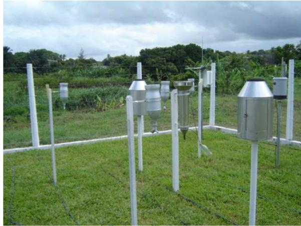
Figura 2 – Vista parcial do ensaio experimental para avaliação do pluviômetro alternativo.
