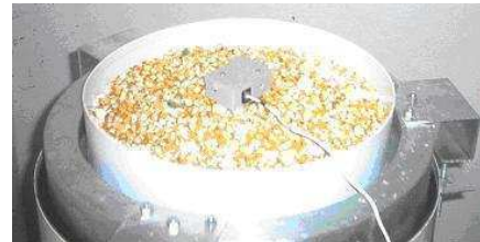
Figura 3. Bandeja do secador sobre a balança com UMETER ®
