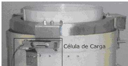
Figura 2. Fotografia da balança com a célula de carga
