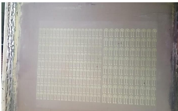
Figura 17 – Tela de Serigrafia revelada.
