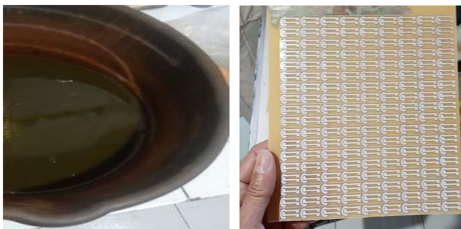
Figura 20 - Remoção de todo o cobre não pintado das placas.
