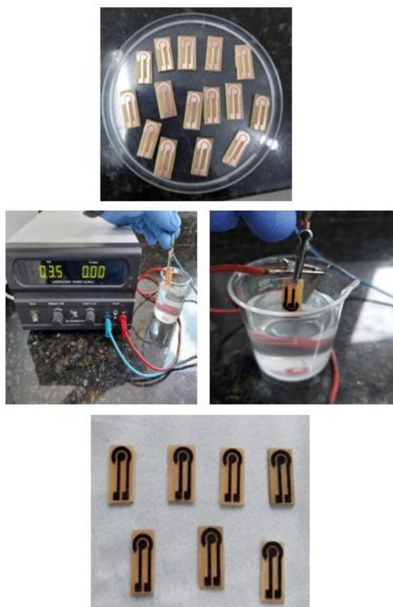
Figura 22 - Processo de eletrodeposição de antimônio nos eletrodos de cobre.
