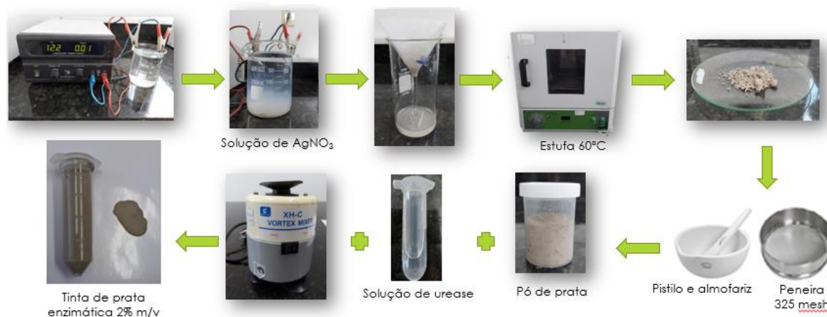
Figura 14 – Procedimento de obtenção da tinta de prata enzimática.
