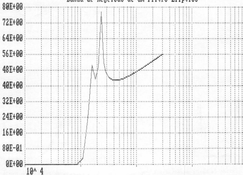
Fig.14 - Exemplo de saída gráfica do Sistema ABCD para curva de atenuação na banda de rejeição de um filtro elíptico.
