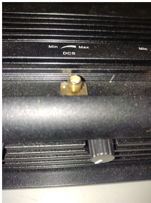
Figura 7 – Potenciômetro para ajuste da intensidade do sinal irradiado.
