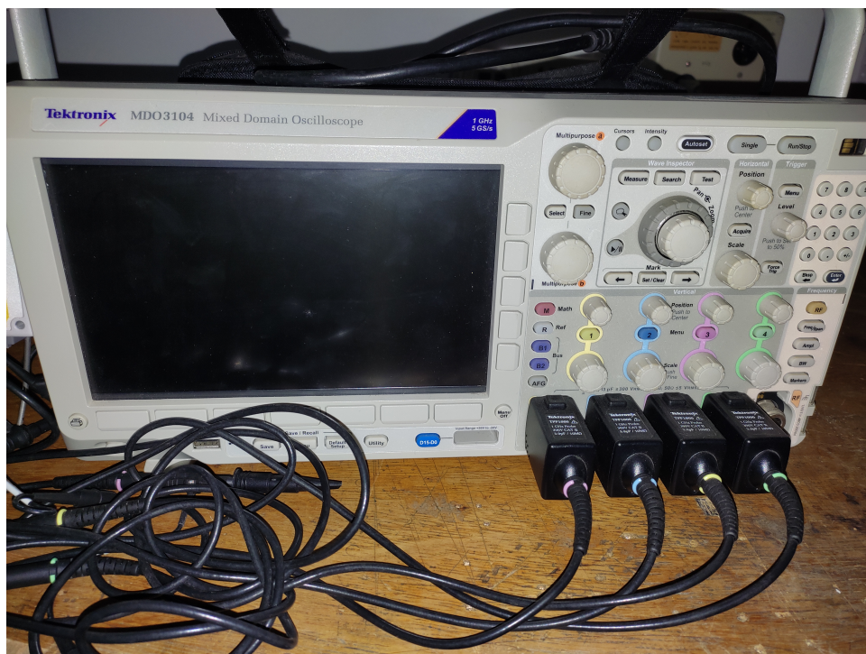
Figura 11 – Osciloscópio que será utilizado para captura do sinal do jammer .
