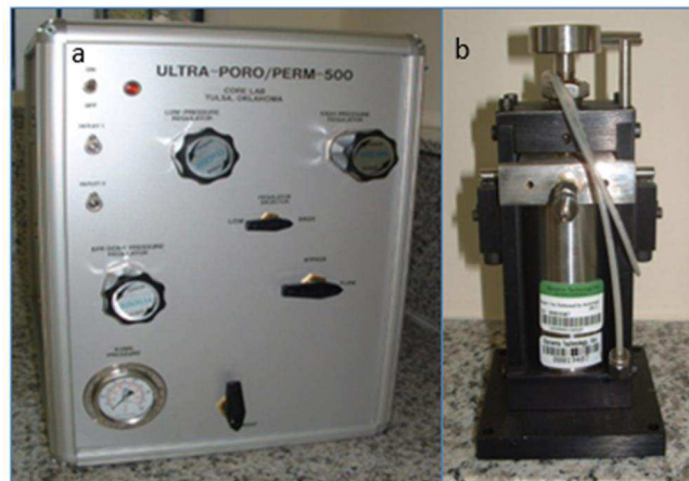
Figura 44: Equipamento utilizado para a medição da porosidade: a) Permoporosímetro; b) Matrix cup .
