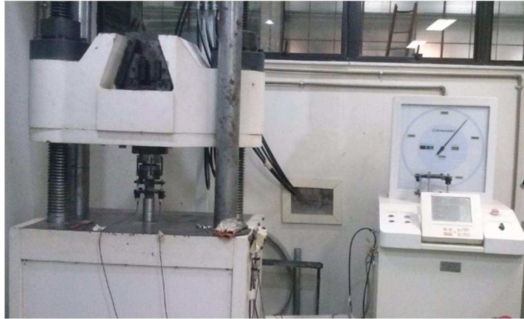
Figura 55: Equipamento para realização do ensaio de compressão uniaxial: prensa Shimadzu.
