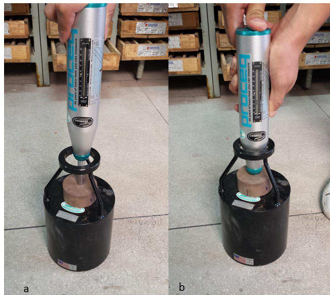
Figura 53: a) amostra posicionada na base de aço; b) amostra recebendo o impacto do martelo de Schmidt.
