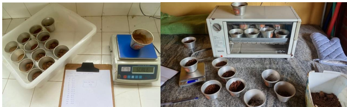
Figura 54. Pesagem e secagem das amostras de solos pelo método do forno elétrico.
