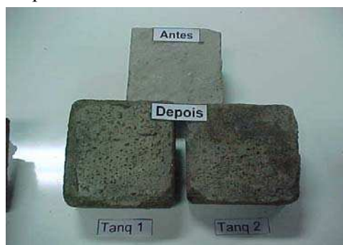
Figura 2 – Detalhe de pontos erodidos nos corpos de prova, após exposição aos dejetos, nos tanques 1 e 2.
