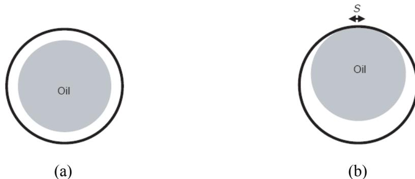
**Figura 2.4:** Posição radial do “core”; (a) posição concêntrica ao eixo do tubo e (b) posição excêntrica ao eixo do tubo. (Fonte: Bensakhria *et al.* 2004).
