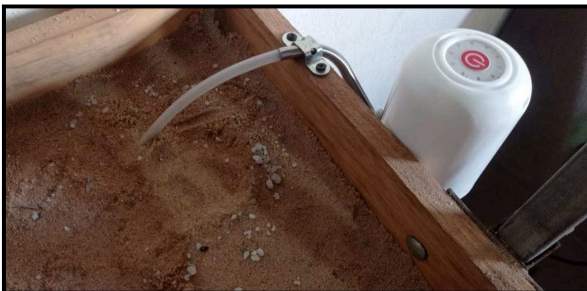
Figura 29 - Minibomba de água integrada ao projeto
