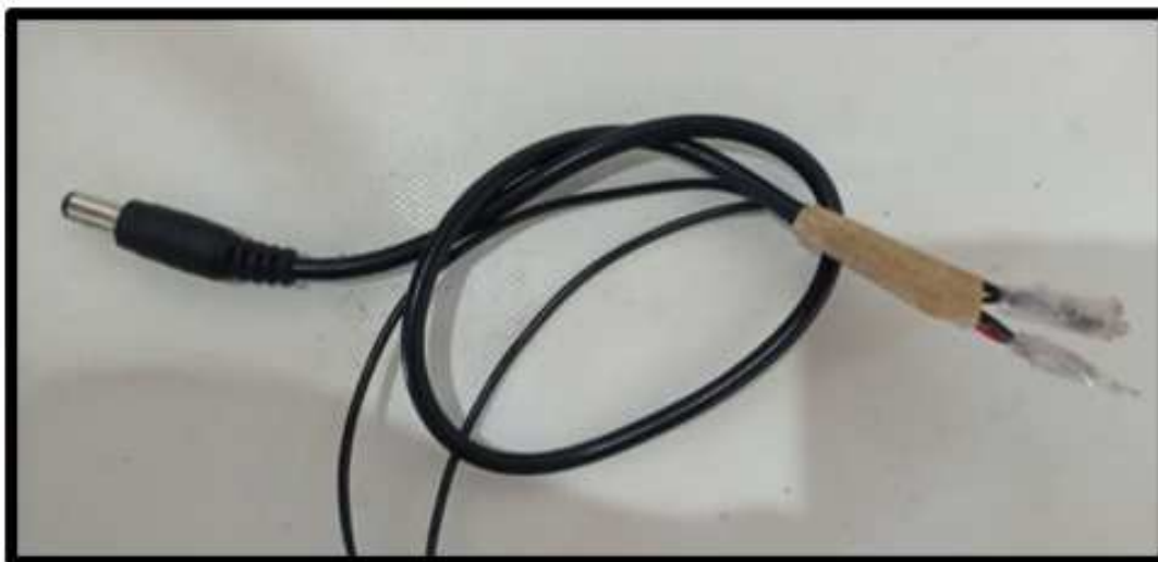
Figura 20 - Adaptação do cabo da fonte
