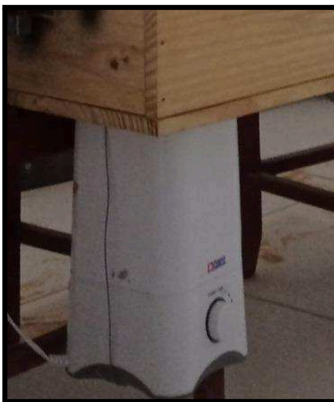
Figura 25 - Equipamento de nebulização acoplado ao projeto
