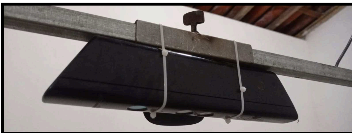
Figura 24 - Fixação do Kinect
