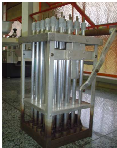
FIGURA 1. Aparelho usado para determinar o tempo de cocção.
