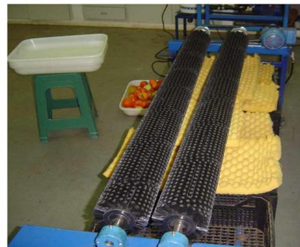
Figuras 1 e 2: Equipamento de classificação: vista lateral (posicionamento das caixas de classificação) e de topo (escovas divergentes)
