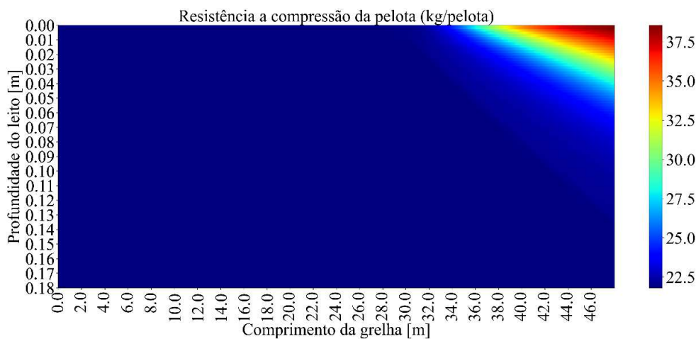
Figura 17. Perfil da resistência à compressão da pelota em função do comprimento do leito.
