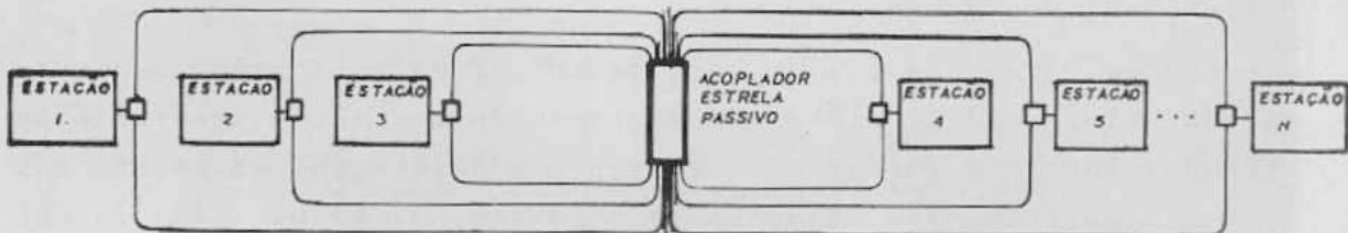
FIGURA - 6 CONFIGURAÇÃO DE BARRAMENTO EM ESTRELA PASSIVO
