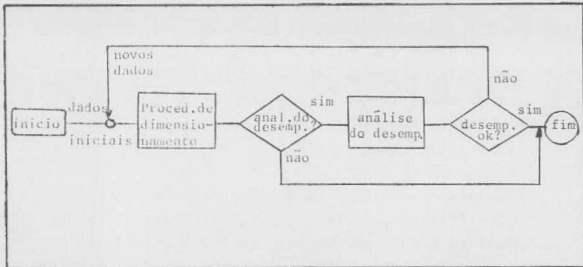
Figura 1 - O Processo de Dimensionamento
