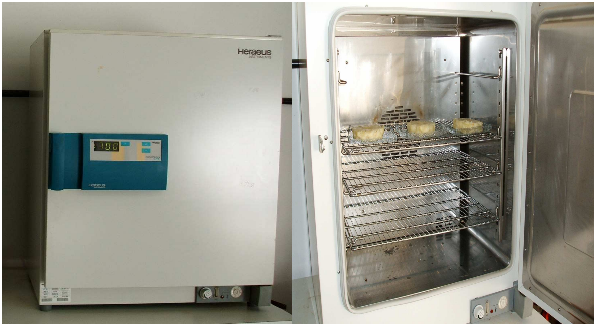
Figura 3.2. Estufa com circulação forçada de ar, fechada (A) e aberta (B).
