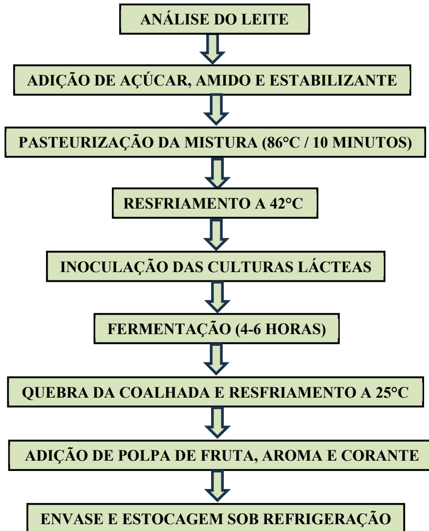
Figura 1 - Fluxograma de um processo de fabricação do iogurte com polpa de fruta.
