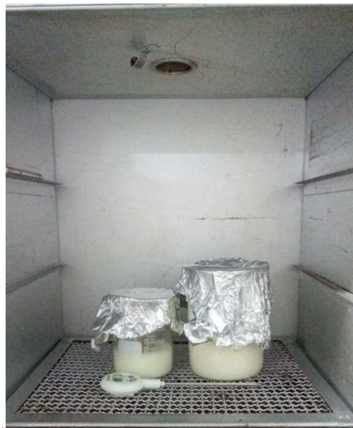
Figura 8: Incubação do iogurte em estufa na temperatura de 42\pm 1 °C
