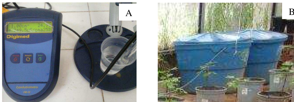
Figura 4 - Condutivímetro de bancada utilizado para leitura da condutividade elétrica da água de irrigação (A) e caixas de água para armazenamento das águas dos distintos níveis de condutividade elétrica (B). Campina Grande, PB, 2015.
