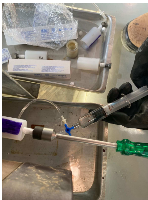
Figura 45 – Procedimento de Extração do Óleo Isolante.
