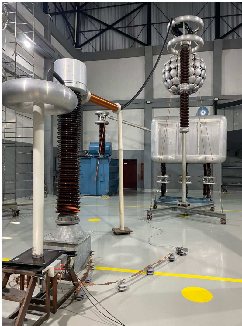
Figura 35 – Montagem do Ensaio de Descargas Parciais.
