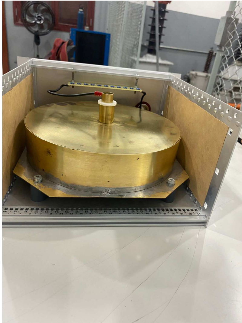
Figura 8 – Compartimento do Circuito de Baixa Tensão do Divisor de Tensão Universal.
