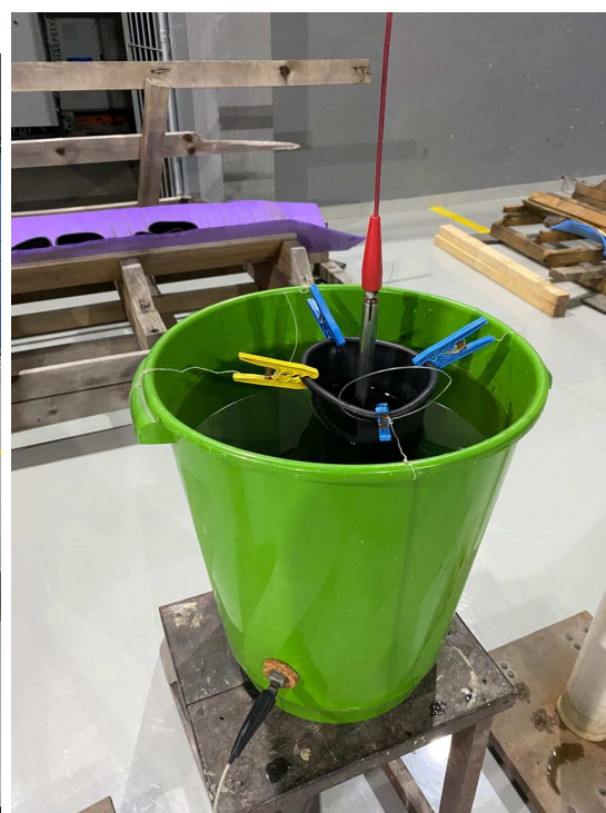
(b). Recipiente Contendo a Água e a Luva Submersa.
