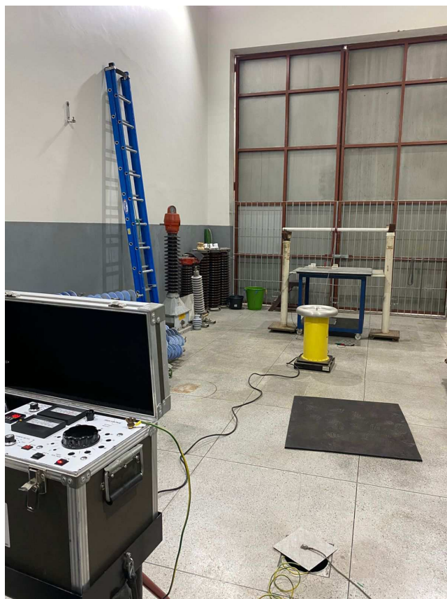
Figura 29 – Montagem para ensaio dos tapetes isolantes, com destaque para a disposição dos equipamentos.
