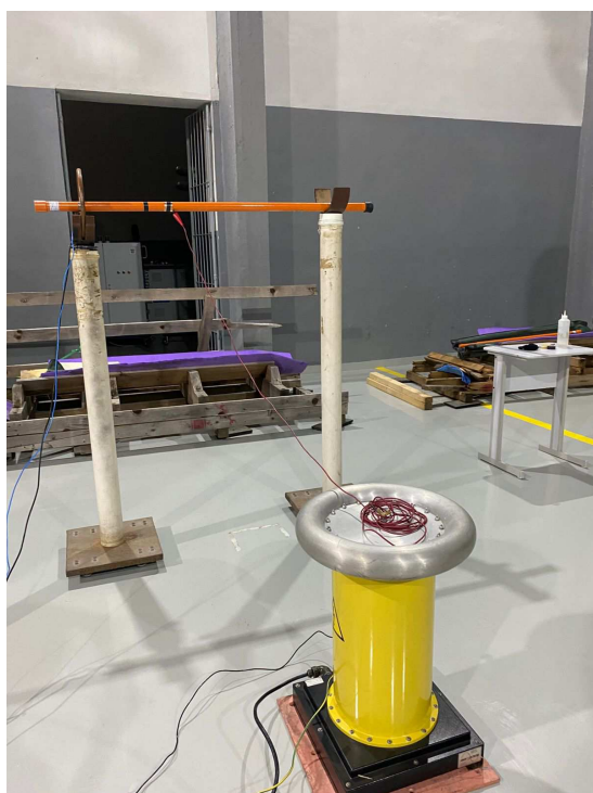
(a). Vista do Ensaio para os Bastões.
