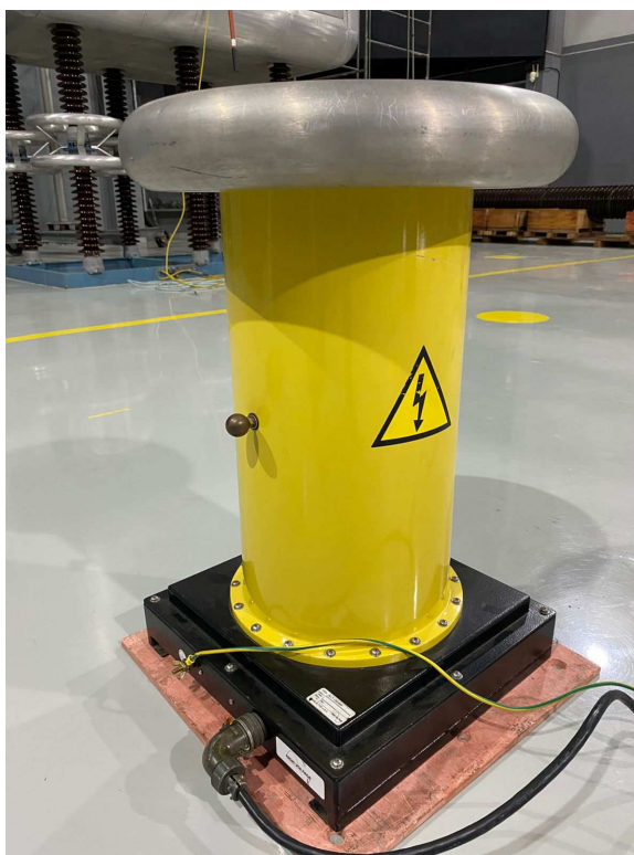
Figura 16 – Gerador de tensão AC, 120 kV- 0,1 A.
