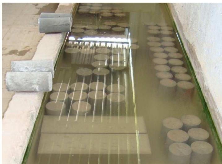
**Figura 4.3** Cura dos corpos – de – prova cilíndricos e prismáticos
