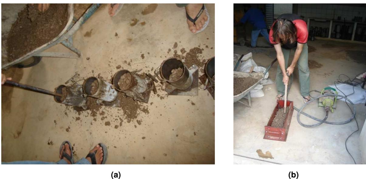
**Figura 3.5** - Moldagem dos corpos – de – prova a) cilíndricos, para os ensaios de compressão simples e b) prismáticos, para os ensaios de tração na flexão.
