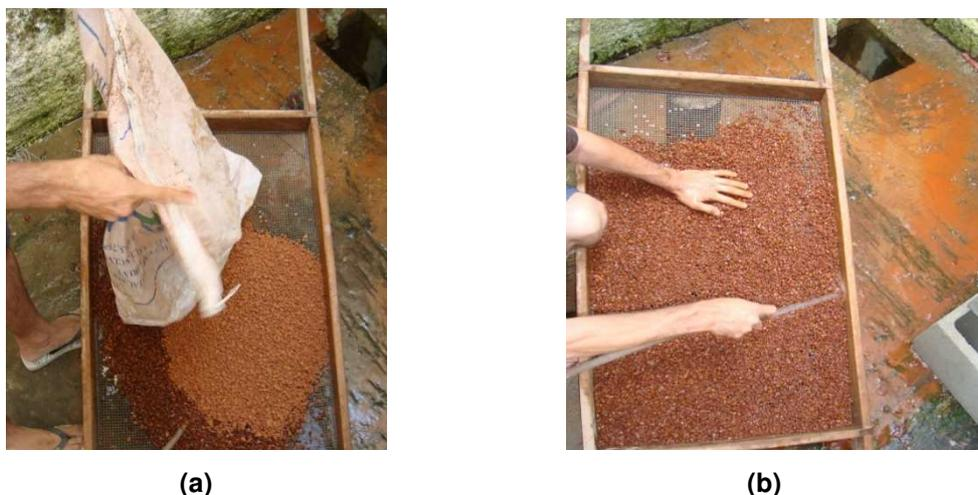
**Figura 3.3** – a) Colocação da laterita na peneira ABNT 4,8 mm b) para lavagem
