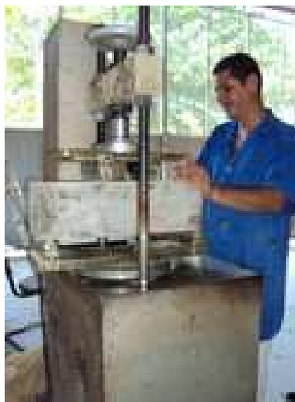
**Figura 3.11** – Ensaio de tração na flexão sob dois cutelos.
