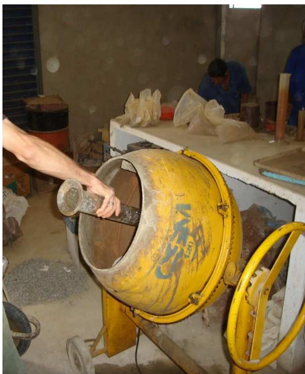
**Figura 3.7** – Colocação da água na betoneira para fabricação do concreto destinado a moldagem dos corpos – de – prova.
