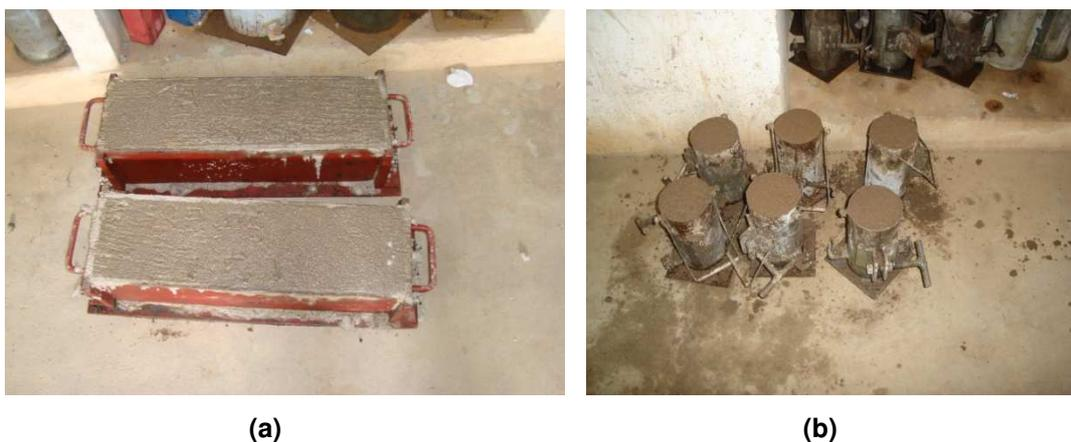
**Figura 3.8** – Corpos – de – prova moldados: a) prismáticos e b) cilíndricos.
