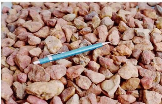
**Figura 2.5** - Agregados lateríticos
