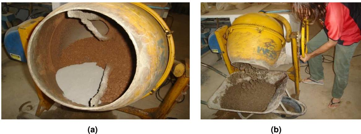
**Figura 3.4** – Preparo do traço do concreto: a) colocação do material na betoneira e b) retirada do concreto.
