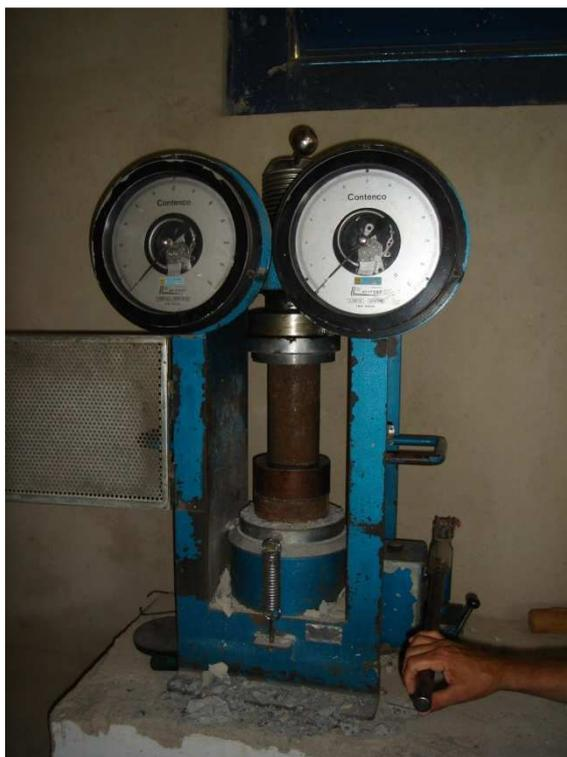
**Figura 3.9** Prensa hidráulica, utilizada para o ensaio de compressão simples
