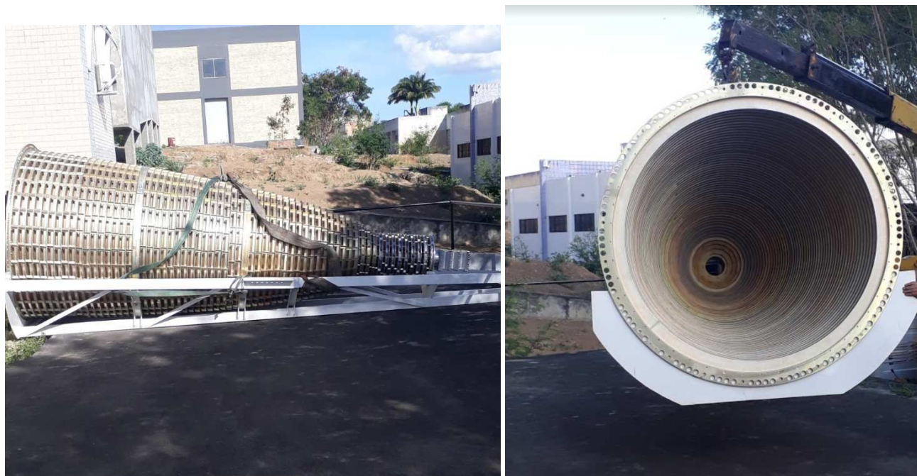
Figura 7 – Imagens do comprimento e do interior da corneta do radiotelescópio BINGO recém chegada na UFCG. Fonte: [55].
