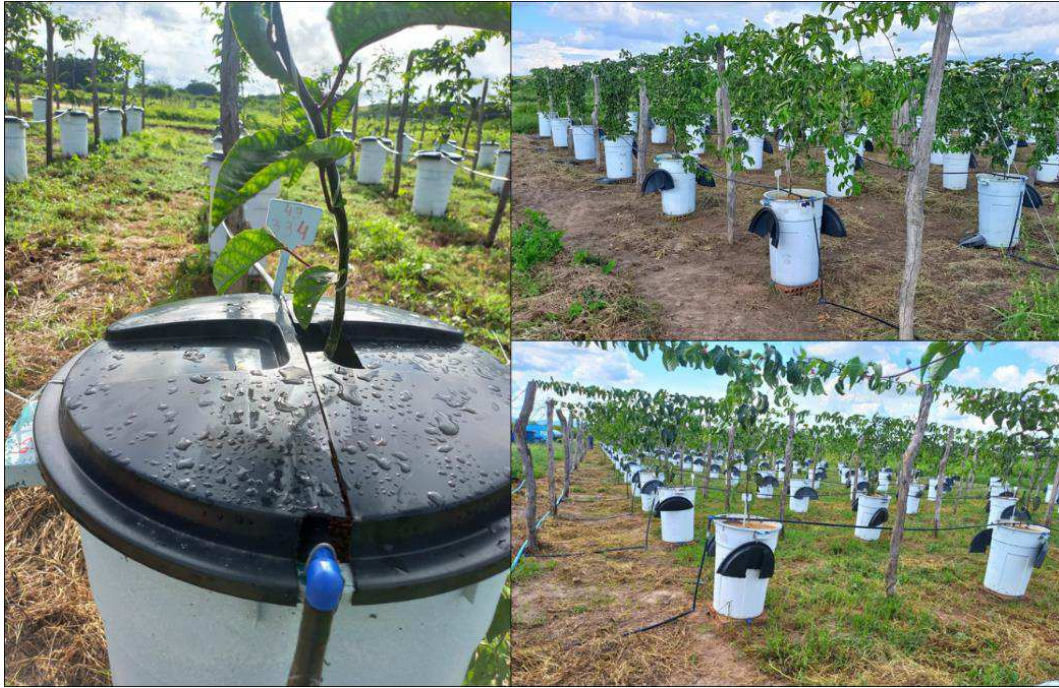
Figura 7. Detalhes do sistema proteção dos lisímetros para impedimento do acúmulo de água no solo durante os eventos de precipitação
