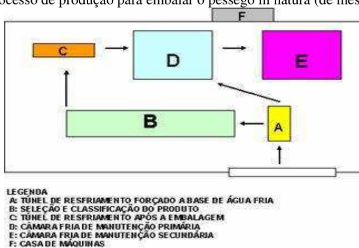
**Figura 1. Ilustração da disposição dos equipamentos na casa de embalagem.**
