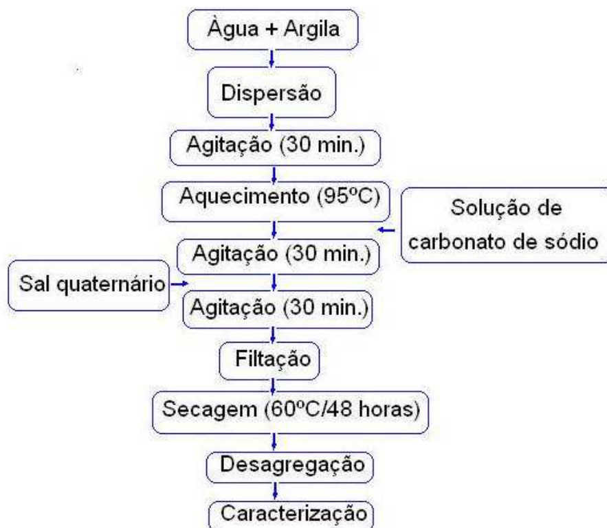
Figura 18: Fluxograma 01 - Preparação de argilas organofílicas na sua forma natural.
