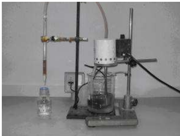
Figura 23: Visão geral do sistema de separação óleo/água
