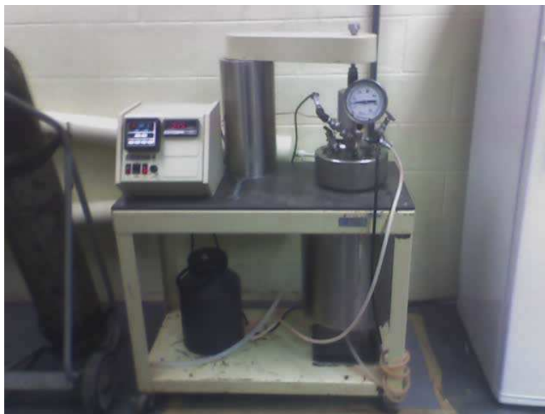
Figura 20: Montagem utilizada para efetuar a Digestão.
