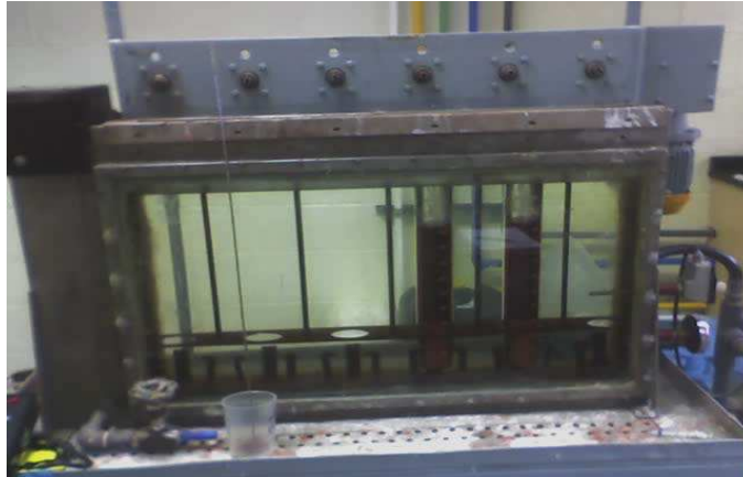
Figura 21: Montagem usada na simulação da Clarificação – decantação nos espessadores.
