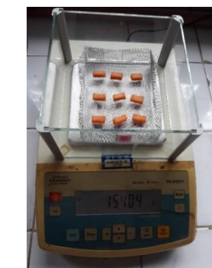
Figura 3.6 - Amostras de paralelepípedos de melão (a); balança digital (b).
