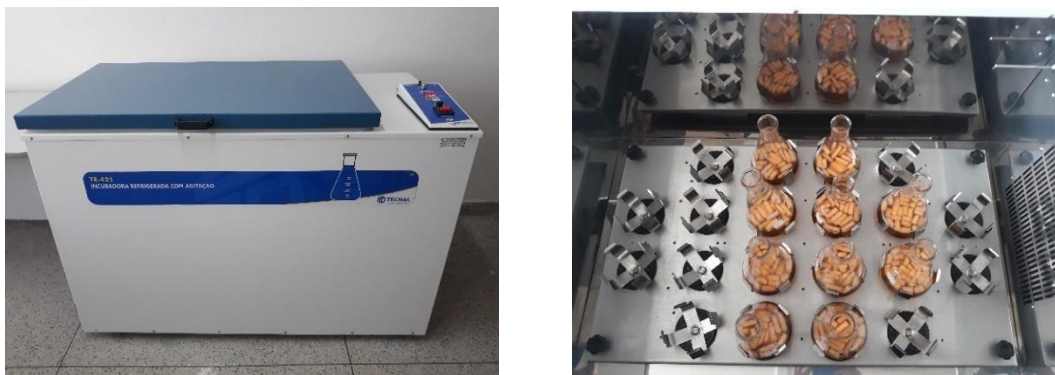
Figura 3.4 - Incubadora refrigerada utilizada para a desidratação osmótica.
