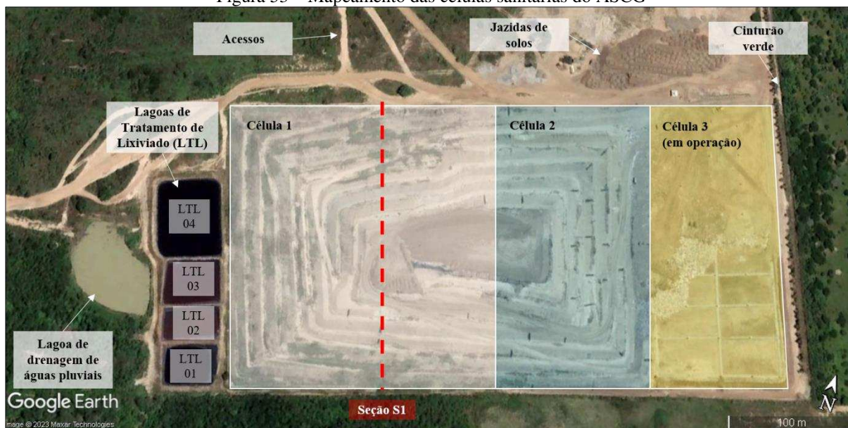
Figura 53 – Mapeamento das células sanitárias do ASCG
