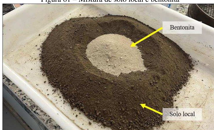
Figura 61 – Mistura de solo local e bentonita
