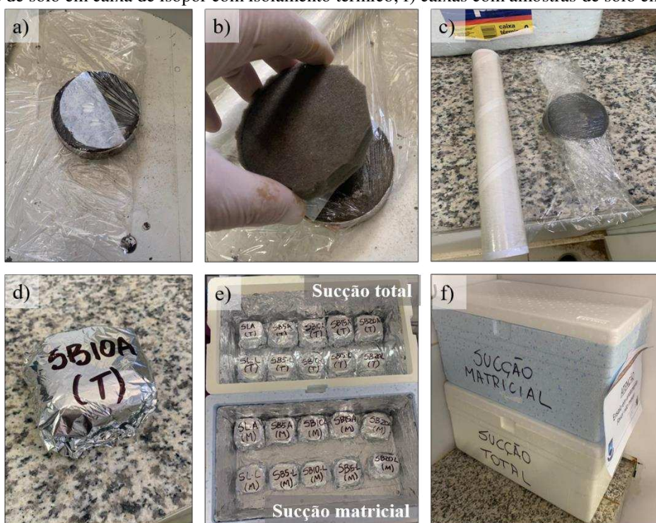
Figura 66 – Procedimento do ensaio de sucção pelo método do papel filtro: a) solo em contato com o papel filtro e envolvido por plástico filme; b) colocação de esponja no contato papel-solo; c) envolvimento de camadas de isolamento de plástico filme; d) isolamento com papel alumínio e identificação da amostra; e) colocação de amostras de solo em caixa de isopor com isolamento térmico; f) caixas com amostras de solo em repouso.
