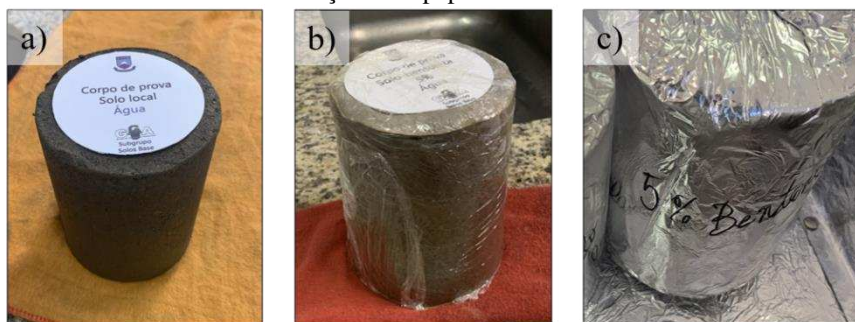
Figura 63 – Corpos de prova moldados: a) identificação da amostra de solo; b) isolamento com plástico filme; c) vedação com papel alumínio.
