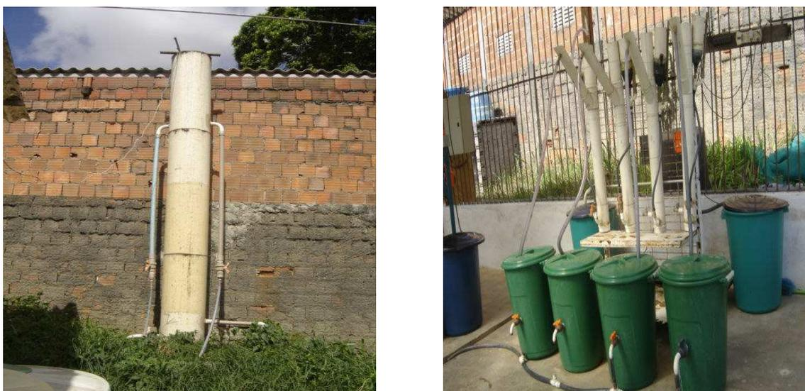
Figura 3. Vista do reator do tipo UASB utilizado no experimento para o tratamento da água residuária, PROSAB/CCT/UFCG, Campina Grande, PB, 2008.
