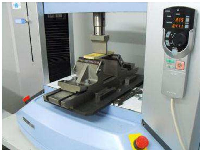
Ensaio iniciais foram realizados para ajustar a velocidade de deslocamento da força; a velocidade aplicada foi de 10 mm/min para um tempo de 60±30 s para a realização dos ensaios.
