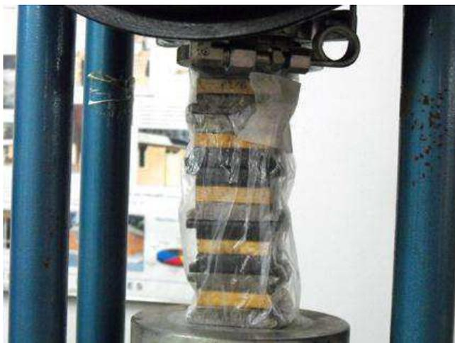
Após colagem os corpos de prova utilizados foram acondicionados em condições de umidade relativa de  $65\pm 5\%$  e temperatura de  $20\pm 3$  °C em uma incubadora modelo 411 (Fabricante: Nova Ética) com faixa de temperatura de 60 °C para que todos os ensaios fossem realizados com amostras nas mesmas condições de colagem e/ou secagem (Figura 39).
