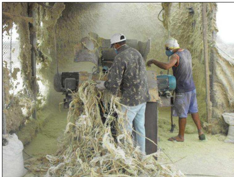
O batimento é o último estágio de beneficiamento da fibra de caroá; basicamente, é uma máquina tubular que funciona girando um eixo central com hastes de aço, em todas as direções, que tem a função de revirar a fibra enquanto os resíduos menores são separados por uma tela de aço (Figura 12).
