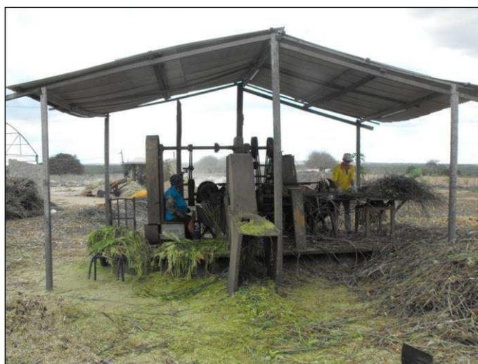
O processo desfibramento pode não processar ou processar parcialmente algumas folhas de caroá; essas folhas são reprocessadas por uma moenda recuperando tais “sobras” (Figura 9).
