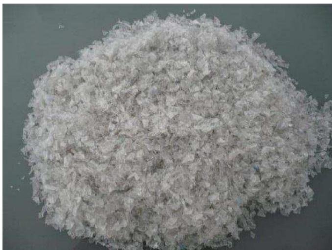
A fibra vegetal de caroá foi adquirida na FIBRANATU, beneficiadora de fibras vegetais, Olivedos - PB (Figura 30). Antes da sua aplicação as fibras adquiridas foram limpas e secadas em estufa, pelo período 24 horas, em temperatura de 60 °C.
