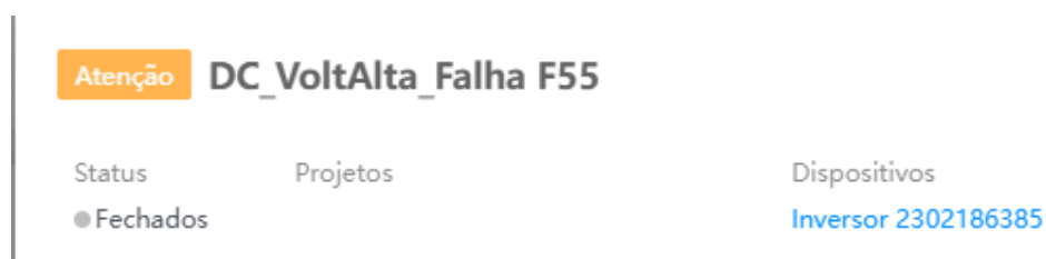
Figura 12 – Aleta de Erro - solarman (Inversor Deye SUN-10K-G)
