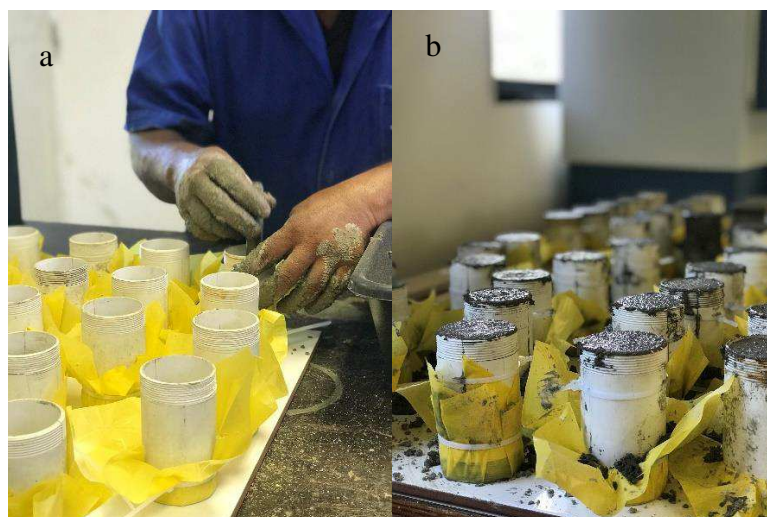
Figura 15. (a) Moldagem das argamassas nos corpos-de-prova; (b) Moldagem das argamassas finalizadas.
