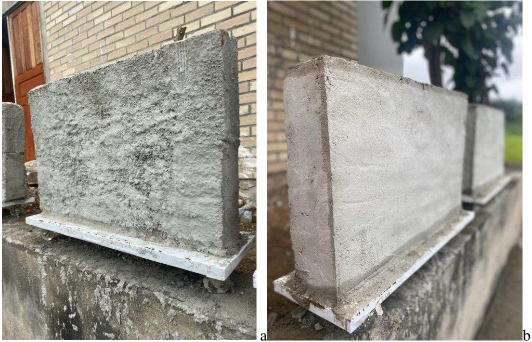
Figura 28. (a) painel de alvenaria chapiscado; (b) painel de alvenaria rebocado.
