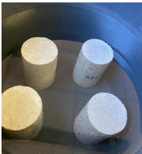
Figura 17. Ensaio de absorção de água por imersão.
