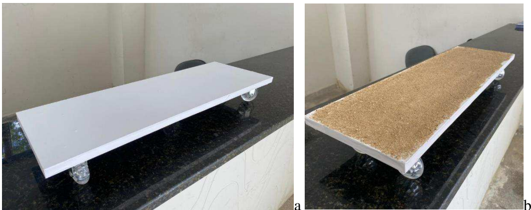
Figura 29. (a) base móvel em MDF revestida com papel adesivo; (b) base móvel em MDF revestida com papel adesivo e com aplicação de película rugosa.
