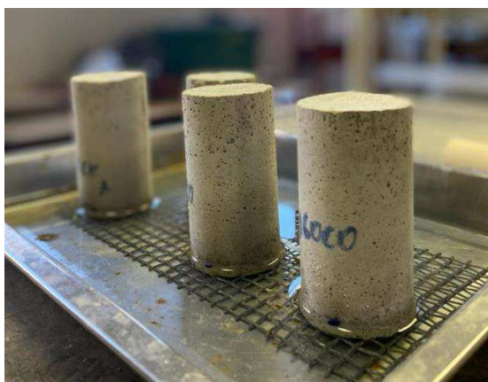
Figura 18. Ensaio de absorção de água por capilaridade.
