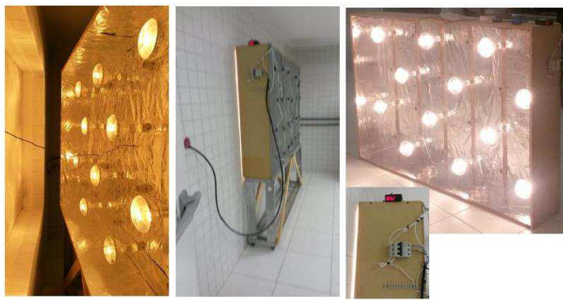
Figura 10. Fonte térmica utilizada para o aquecimento da face externa do painel.
