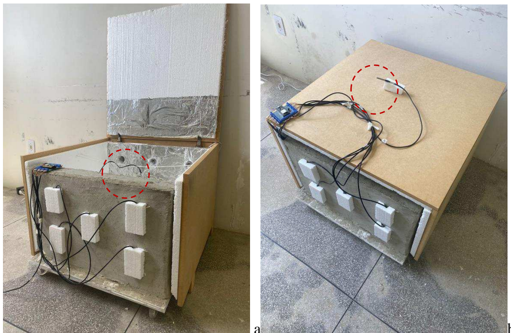
Figura 26. (a) distribuição dos sensores na mini parede de alvenaria e sensor do ambiente interno da caixa térmica II; (b) caixa térmica II fechada com sensor na parte externa.
