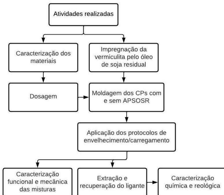
A primeira etapa do trabalho consistiu na caracterização física dos agregados e do ligante, a fim de atestar a viabilidade do uso destes para produção de misturas asfálticas. Além disso, foi realizada caracterização da vermiculita e do óleo residual e, posteriormente, foi feito o processo de saturação, como esquematizado no fluxograma da Figura 17.
