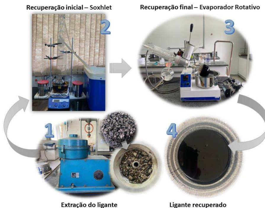
Devido a capacidade do balão utilizado no evaporador rotativo, optou-se por fazer uma recuperação prévia do solvente com a utilização de um Soxhlet, ilustrado na Figura 38. A metodologia consistiu na imersão parcial de um balão volumétrico, contendo a solução que será recuperada, em um banho de óleo vegetal aquecido. Com esta etapa inicial, foi possível reduzir o volume da solução de 1500ml para 300ml,
