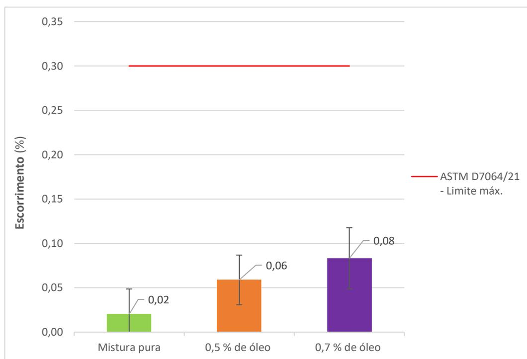
Figura 58 – Resultado do ensaio de escorrimento
