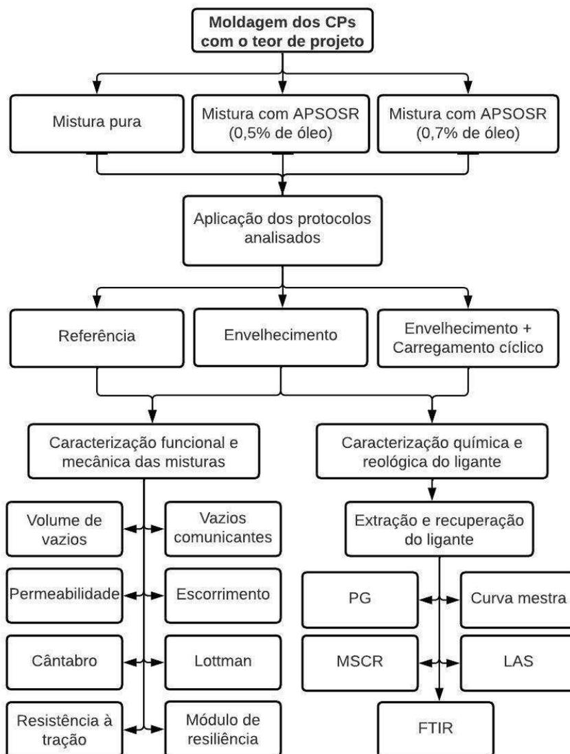
A caracterização funcional e mecânica das misturas asfálticas foi realizada após estas serem trabalhadas em três condições diferentes, sendo estas: mistura de referência, mistura envelhecida e mistura envelhecida com aplicação de um carregamento cíclico. Em paralelo, das misturas submetidas à estas condições, foram extraídos e recuperados os ligantes para análise da capacidade de rejuvenescimento após a incorporação do APSOSR.
