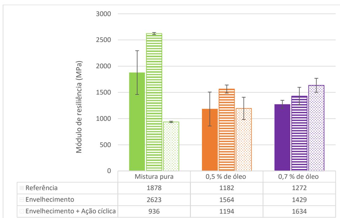
É importante destacar que o módulo de resiliência está associado à rigidez da mistura, portanto, sua análise não pode ser feita de forma direta, permitindo, assim, valores menores ou maiores, mas que sejam compatíveis com a estrutura do pavimento e as deformações entre suas camadas (GAMA, 2013). No entanto, uma baixa rigidez evita alta absorção de tensões que levam ao trincamento prematuro do revestimento (BERNUCCI *et al.*, 2022)
