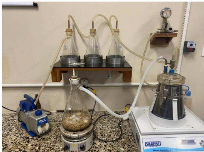
Esse processo continuou enquanto as bolhas de ar continuassem aparecendo sob vácuo. Posteriormente, o vácuo foi liberado e o frasco voltou à pressão ambiente. Qualquer excesso de rejuvenescedor foi recuperado por filtração e o APSOSR foi seco em estufa até peso constante. Na Figura 24 é exposta a vermiculita, antes e após o processo de impregnação.
