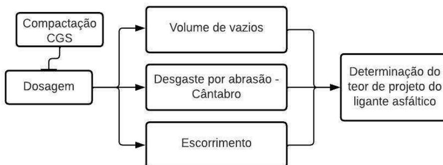
Na terceira etapa, delineada na Figura 19, foram moldados corpos de prova provenientes da mistura pura e das misturas modificadas pela adição do APSOSR.
