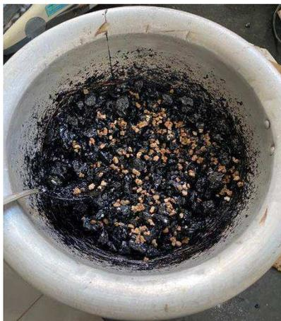
Com a finalidade de simular o envelhecimento de curto prazo, o material permaneceu em estufa por 4 horas. Então, as misturas foram compactadas no CGS, não diferindo do processo utilizado para compactar as misturas asfálticas puras. Na Figura 35 pode-se observar a aparência dos corpos-de-prova, com e sem APSOSR.
