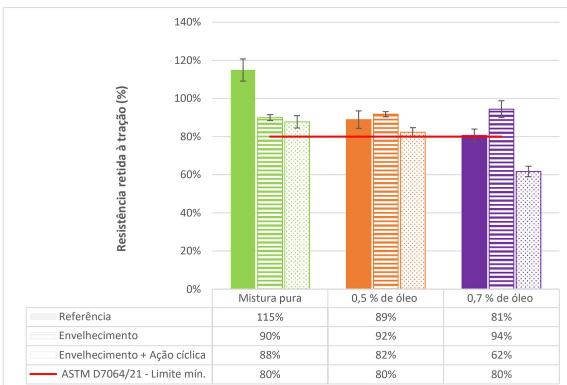
A ASTM D7064/21 sugere que o critério de definição da suscetibilidade à umidade de uma mistura seja de no mínimo 80% de RRT, ou seja, a perda máxima de resistência deve ser de 20% após o condicionamento, em relação ao valor de referência. Logo, todas as misturas apresentam valores de RRT dentro do limite estabelecido pela especificação americana.
