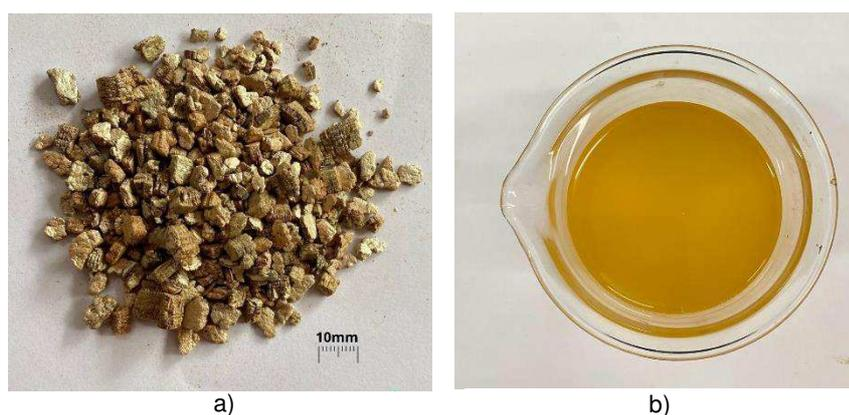
LI *et al.* (2021) atestaram que a vermiculita possui grande área superficial e boa capacidade de absorção, o que motivou a escolha desta como material carreador do óleo residual. A vermiculita foi adquirida no comércio local, com a classificação comercial de vermiculita expandida média.
