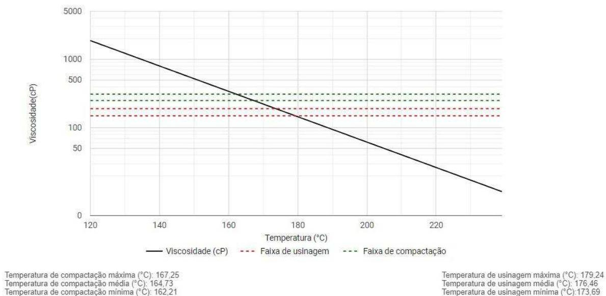
Com base na curva de Temperatura *versus* Viscosidade, da Figura 28, a temperatura de usinagem foi de 176°C, e a de compactação 165°C. Esse método é utilizado para ligantes virgens, no entanto, não é a mais adequada para ligantes modificados. Apesar disto, Domingos *et al.* (2012) afirmam que a aplicação das faixas de viscosidade tradicionais é uma simplificação que também tem sido utilizada para determinar a temperatura de usinagem (TU) e temperatura de compactação (TC) de ligantes modificados.
