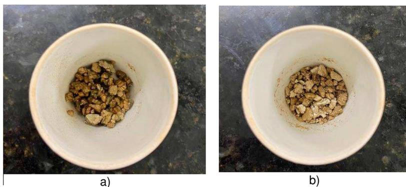
Dado que o óleo é totalmente degradado termicamente nas condições do ensaio, devido à sua natureza orgânica, o resíduo obtido foi pesado e a diferença do peso inicial indica a quantidade de rejuvenescedor que estava aderida dentro dos poros do agregado. Logo, a eficiência de impregnação aferida foi de 81,3%, ou seja, da massa total de vermiculita saturada em óleo de soja residual, 81,3% correspondem a presença de óleo nos poros do agregado poroso.
