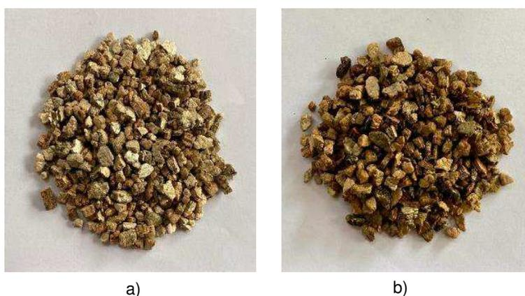
Após a saturação, o agregado poroso foi armazenado à temperatura ambiente por até dois meses, sem que fossem observadas alterações visuais. É importante destacar que se optou por não realizar uma nova análise granulométrica na vermiculita saturada com o óleo de soja, visto que visualmente não foi constatada variações na granulometria no material.
