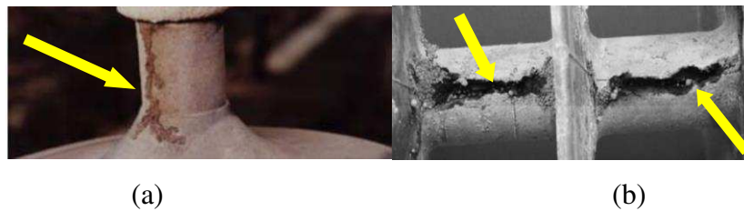
Figura 8 – Fotografias de Isoladores Poliméricos com Trilhamento.
