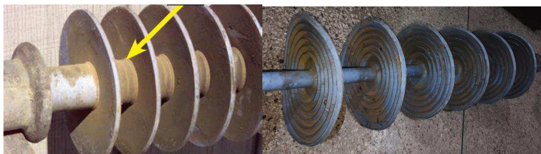
Figura 11 – Fotografias de Isoladores Poliméricos Poluídos.
