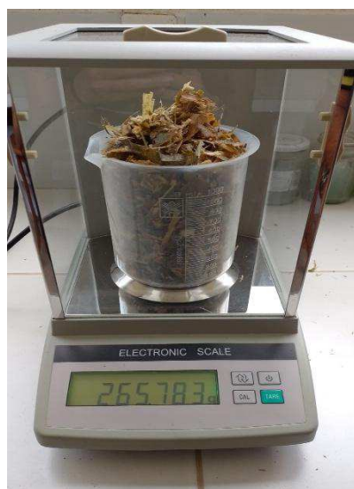
Figura 11. Pesagem da amostra de silagem de milho, para ser enviada ao laboratório.
