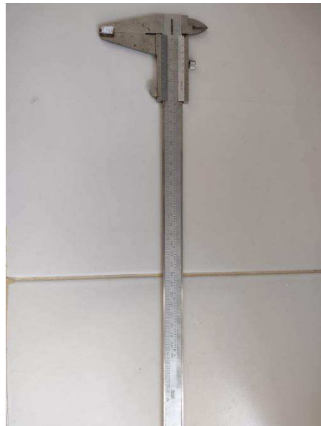
Figura 15. Paquímetro utilizado para obter as medidas da altura da parte aérea e diâmetro do caule das mudas de melancia.
