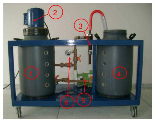
Figura 3.4 – Sistema de purificação de argilas com uso do hidrociclone
