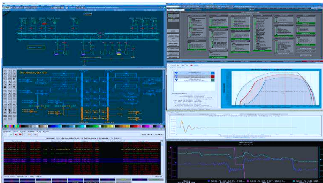
Figura 2 – Curvas de capacidade de gerador calculadas dinamicamente
