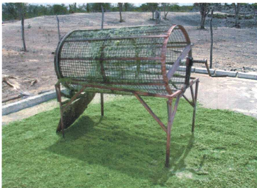
Figura 10. Peneira rotativa utilizada para separar a bucha da mucilagem do sisal. (Foto: Wirton Macedo Coutinho)
