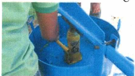
Figura 11. Prensa hidráulica itinerante de acionamento manual (A), Prensa sendo abastecida com resíduo do desfibramento (B), Acionamento do macaco para extração do extrato (C) e Extração do extrato do resíduo (D).
