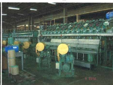
Figura 6. Detalhe da máquina good para a formação de mechas (A), Detalhe da máquina good para a formação de mechas (B), Detalhe da fiadeira para a confecção do fio (C) e Detalhe da fiadeira e formação das bobinas de fios (D). Foto: Odilon Reny R. F Silva
