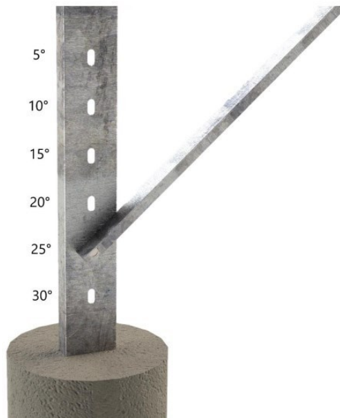
Figura 22: Regulagem da Angulação da Estrutura de Fixação em Solo.
