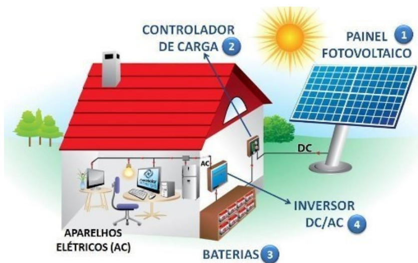
Figura 2: Demonstração de um Sistema Fotovoltaico Off-grid.
