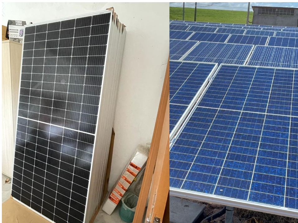
Figura 5: Módulo Monocristalino e Policristalino.
