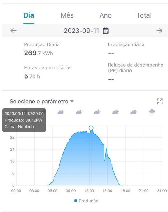
Figura 17: Monitoramento da Geração de um Sistema Fotovoltaico.
