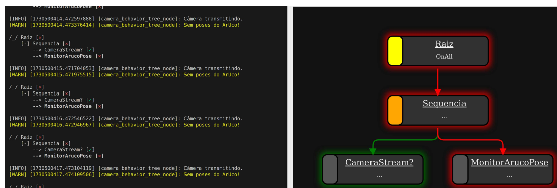
Figura 32 – Falha na detecção do marcador ArUco, indicada pela borda vermelha.
