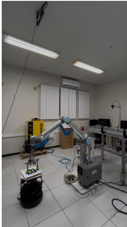
Figura 35 – Robô UR10 executando a tarefa de manipulação com base na pose detectada do marcador ArUco.
