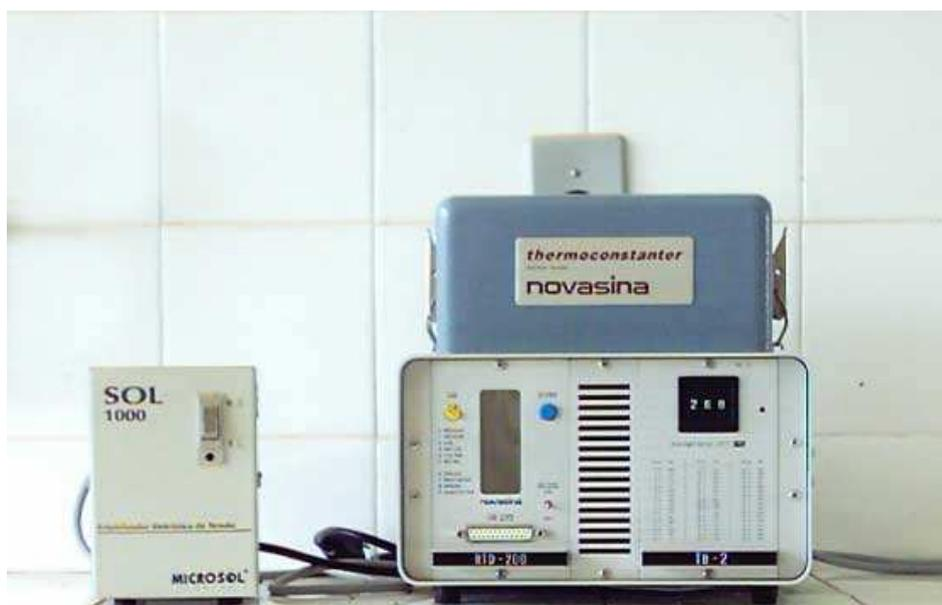
Figura 3.8 – Equipamento Thermoconstanter Novasina modelo TH-02.
