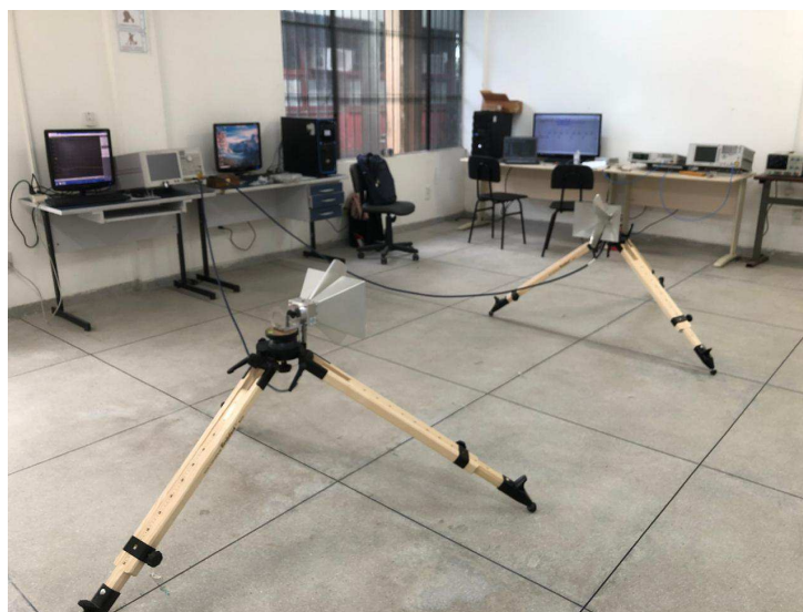
Figura 14 – Setup de medição de ganho
