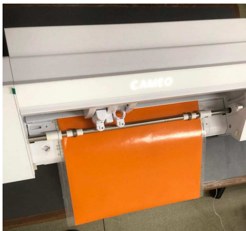
Figura 4 – Cortes no adesivo sendo realizados na Silhouette
