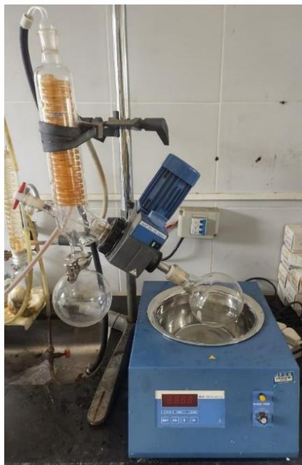
**Figura 6** - Evaporador rotativo.
