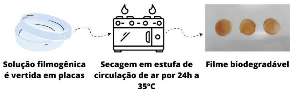
**Figura 5** - Processo de casting utilizado na produção de filmes
