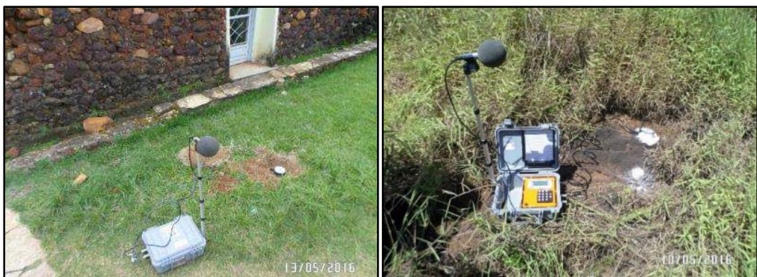
Figura 21 e 22 – Alocação dos sismógrafos
