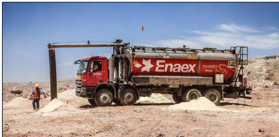
Figura 9 - Unidade Móvel de Bombeamento (UMB)
