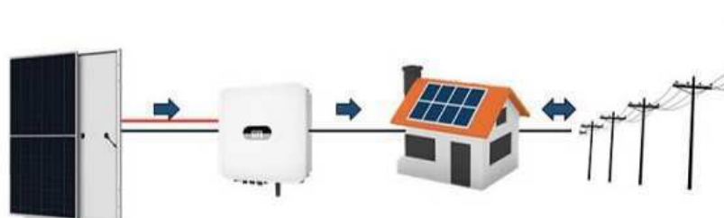
Figura 1 – Sistema de geração on-grid .
