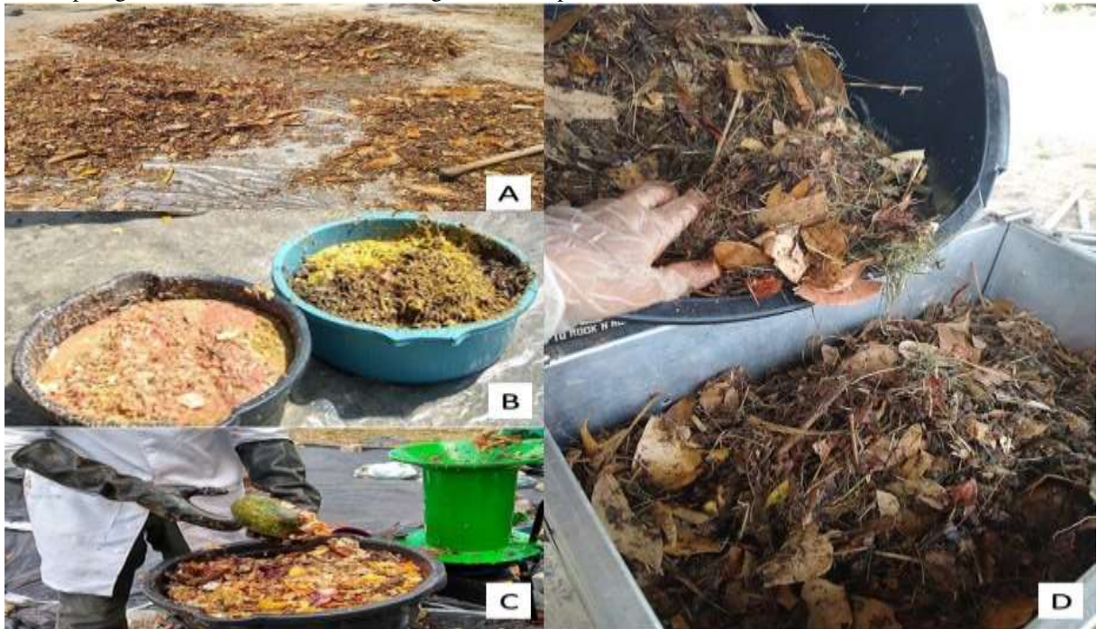
Figura 12. Etapas para montagem do sistema. Foto A: método do quarteamento para retirada das amostras. Foto B e C: pesagem do substrato. Foto D: montagem das composteiras.
