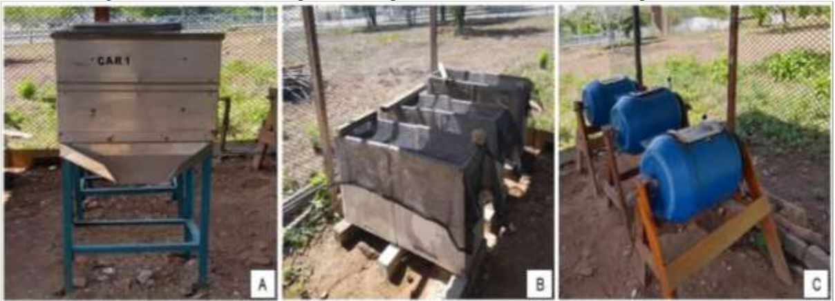
Figura 5. Sistemas de composteiras. Foto A: composteiras de aço inoxidável (CAR); Foto B: composteiras de concreto retangular (CCR); Foto C: composteiras de polietileno cilíndrico (CPC). Campina Grande – PB.
