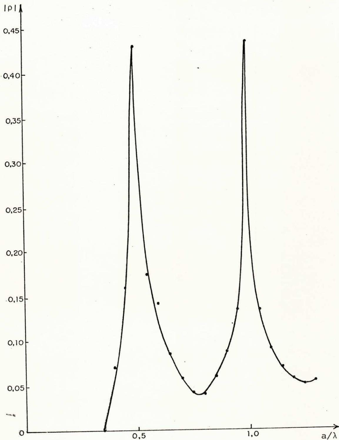
Fig. 5.7 - Módulo do coeficiente de reflexão  $\rho$  em função de  $a/\lambda$  , com  $b/\lambda = 0,35$ .
