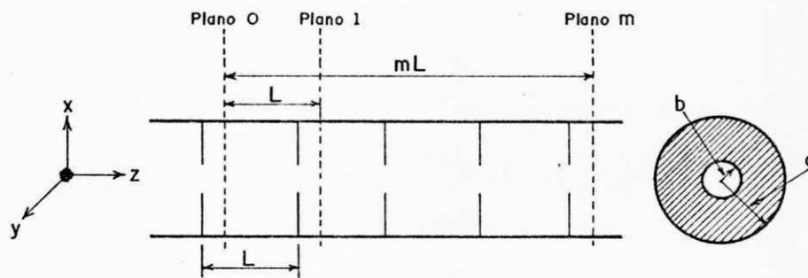
Fig. 2.5 - Guia de ondas cilíndrico carregado periodicamente.
