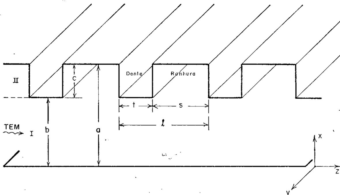
Fig. 3.1 - Linha de transmissão de planos paralelos com carregamento periódico capacitivo.
