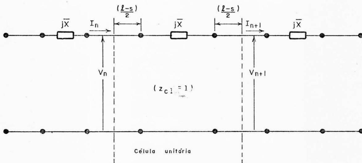
Fig. 3.5 - Circuito equivalente mostrando uma célula unitária.
