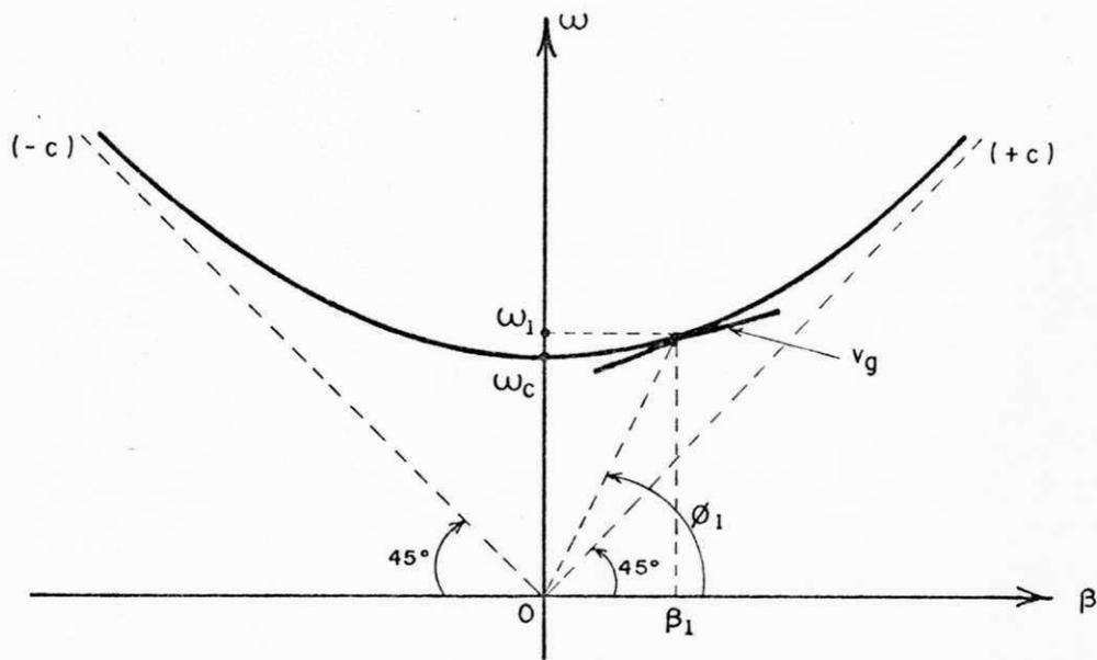
Fig. 2.4 - Diagrama  $\omega - \beta$  para o guia de ondas.
