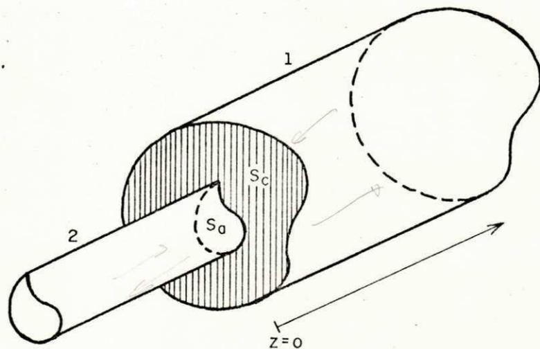
Fig. 4.1 - Junção de dois guias de ondas cilíndricos
