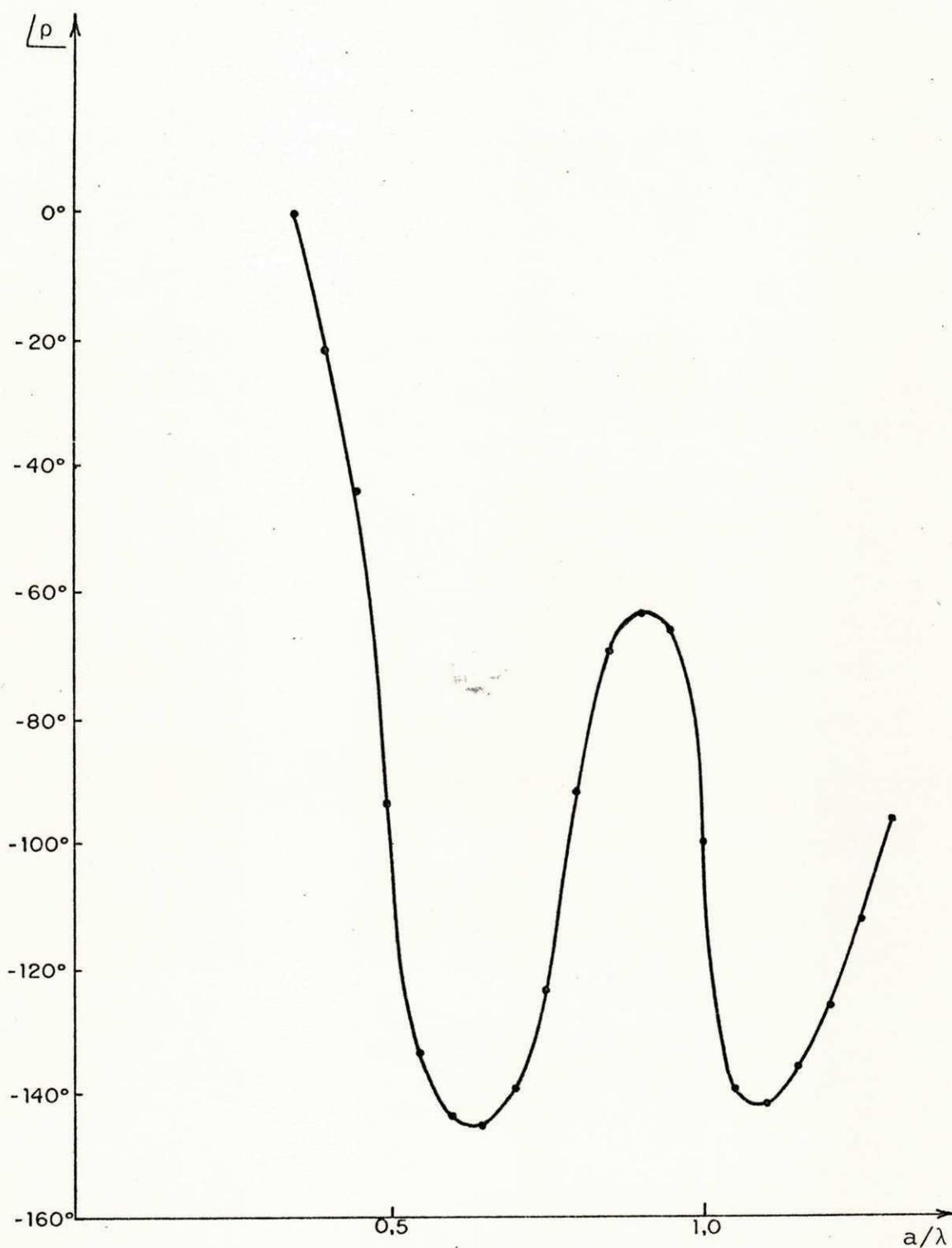
Fig. 5.8 - Fase do coeficiente de reflexão  $\rho$  em função de  $a/\lambda$ , com  $b/\lambda = 0,35$ .
