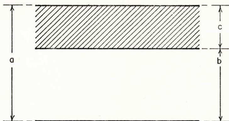
Fig. 5.2-b - Vista frontal da linha de transmissão de planos paralelos carregada capacitivamente com diafragmas espessos.
