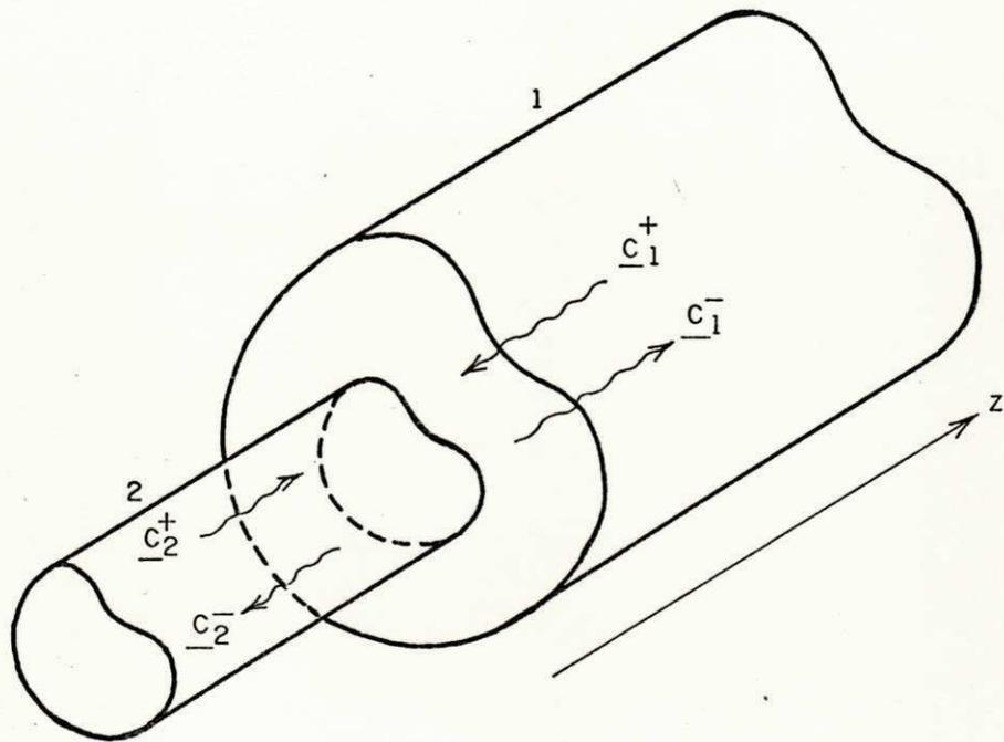
Fig. 4.2 - Representação dos vetores amplitude de modo incidentes e espalhados
