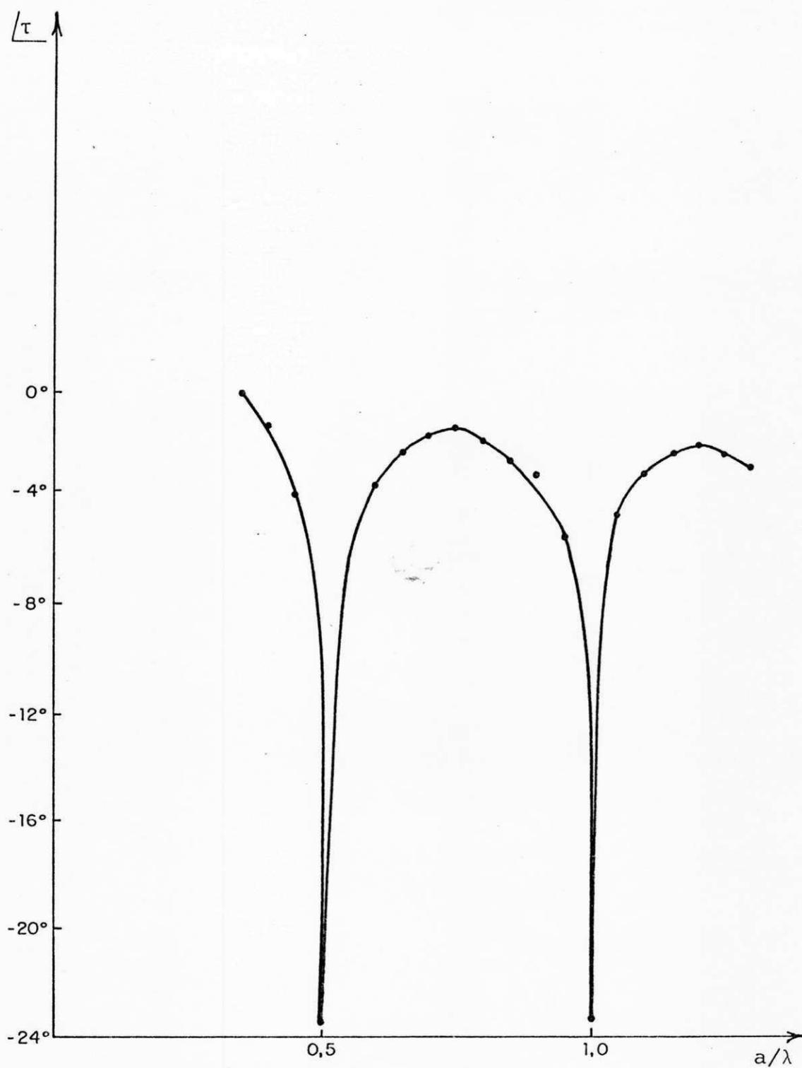
Fig. 5.10 - Fase do coeficiente de transmissão  $\tau$  em função de  $a/\lambda$  , com  $b/\lambda = 0,35$ .
