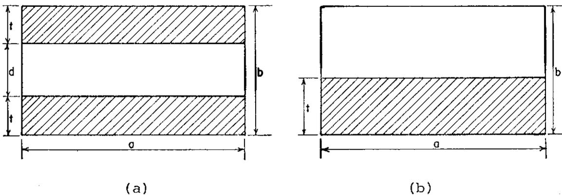
Fig. 2.2 Elementos capacitivos em paralelo
