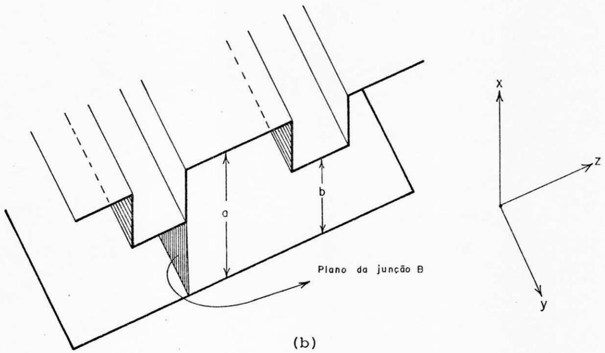
Fig. 5.5 (a) e (b) - Detalhes da junção de duas linhas de transmissão de planos paralelos.
