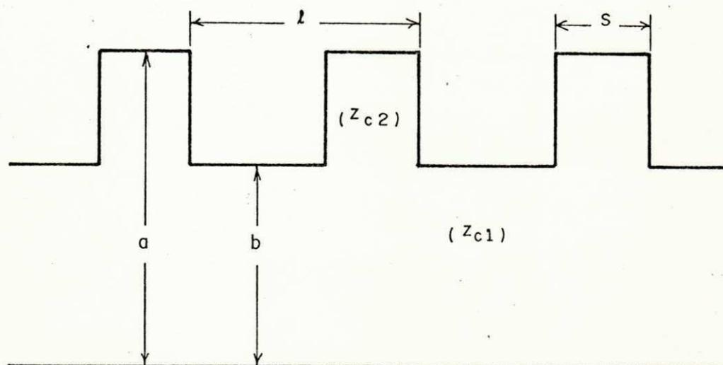
Fig. 3.4 - Representação em linha de transmissão do guia de planos paralelos periodicamente carregado.
