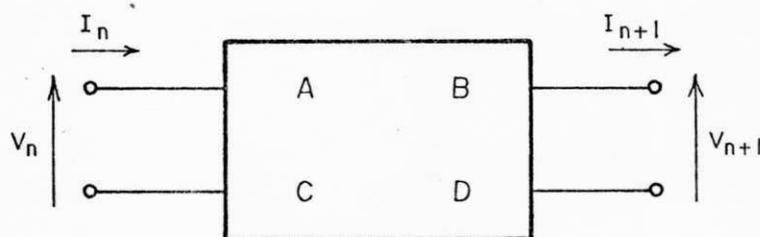
Fig. 3.3 - Representação de uma célula unitária pela matriz transmissão de tensão e corrente (matriz ABCD).
