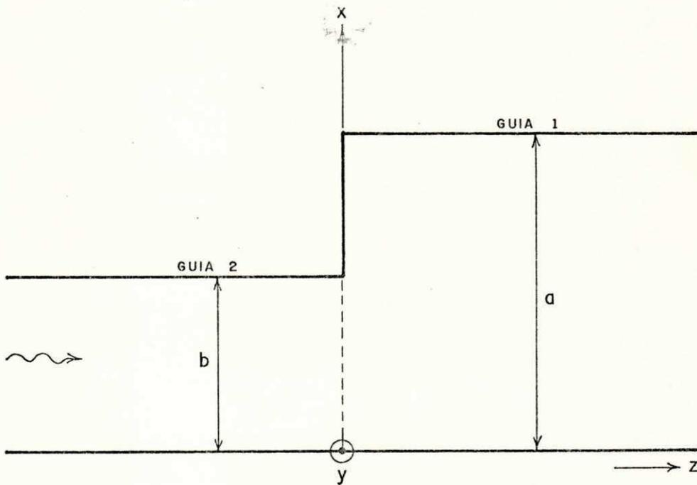
Fig. (B-1) - Junção entre dois guias de ondas de planos paralelos.
