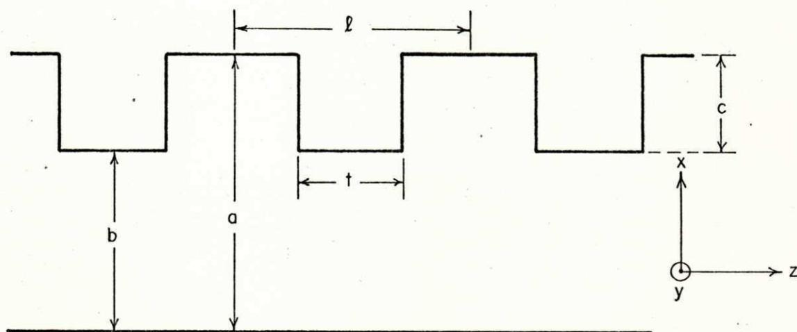
Fig. 5.2-a - Vista lateral da linha de transmissão de planos paralelos carregada capacitivamente com diafragmas espessos.
