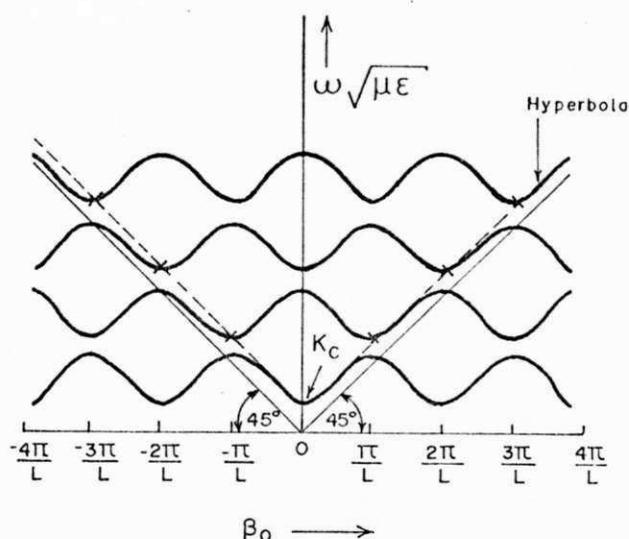
Fig. 2.6 - Característica de dispersão do guia cilíndrico periodicamente carregado.
