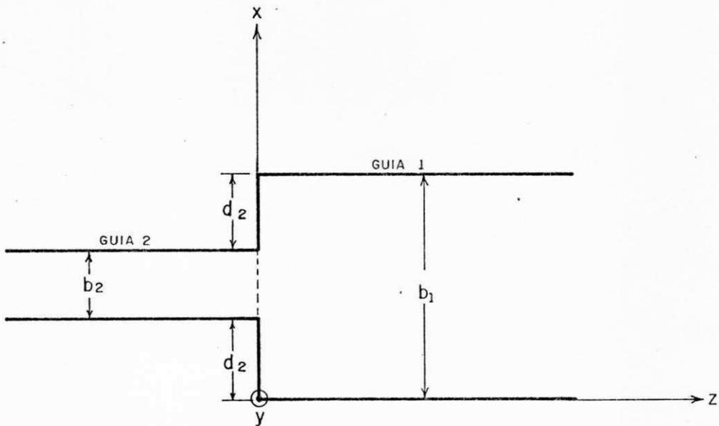
Fig. (D-1) - Junção entre dois guias de ondas retangulares.
