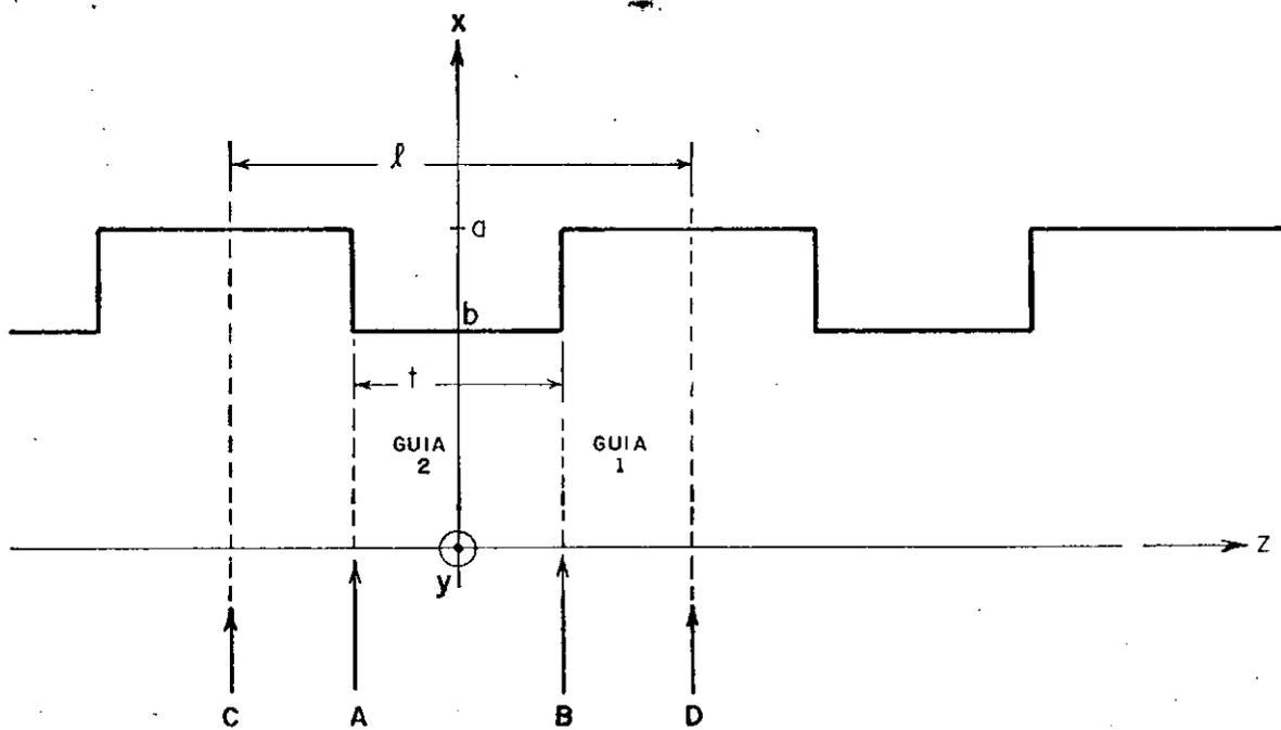
Fig. (C-1) - Guia de ondas de planos paralelos com carregamento periódico.
