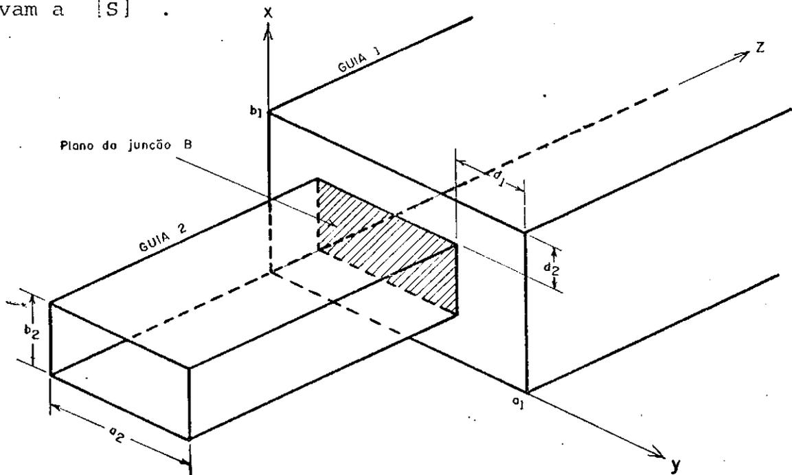
Fig. 5.12 - Junção entre dois guias retangulares desiguais, destacando o plano da junção B.
