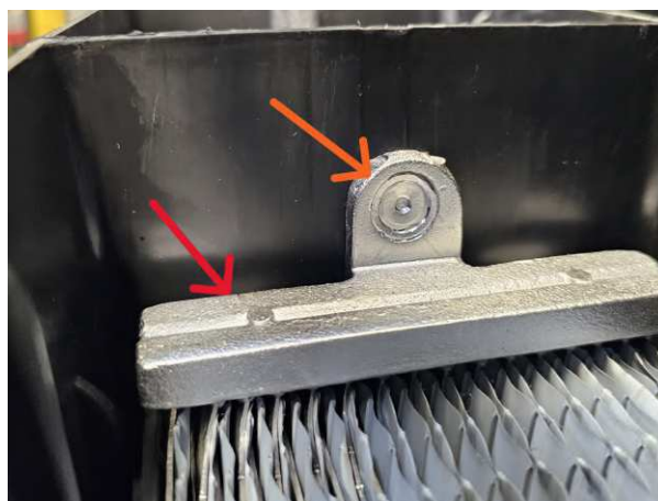
Figura 3.11: Fotografia do strap e da solda intercell - Visão Frontal
