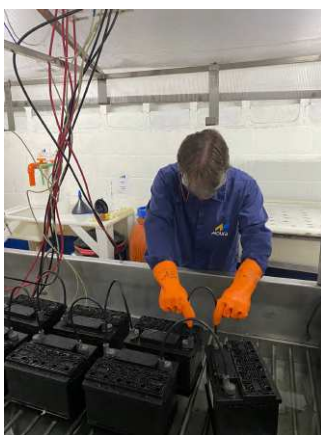
Figura 4.3: Fotografia da formação das baterias
