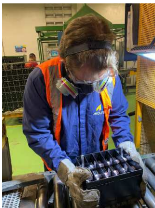
Figura 4.2: Fotografia da montagem das baterias
