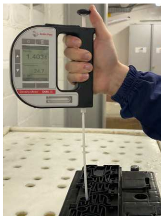
Figura 4.4: Fotografia da Medição de densidade de eletrólito
