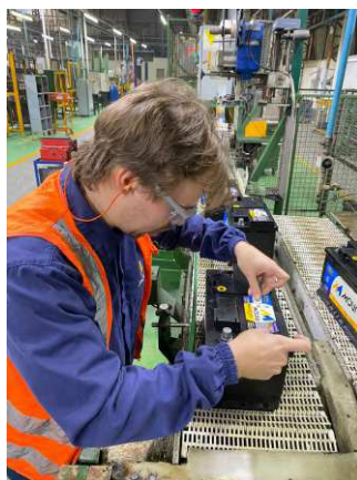
Figura 4.5: Fotografia do acabamento das baterias
